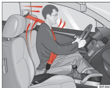
Abb. 41 Angegurter Fahrer, der bei einem plötzlichen Bremsmanöver vom richtig angelegten Sicherheitsgurt aufgefangen wird.
