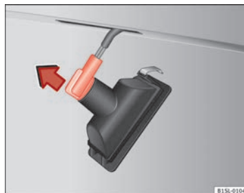
Abb. 156 Kennzeichenleuchte: Lampenhalter ausbauen.
