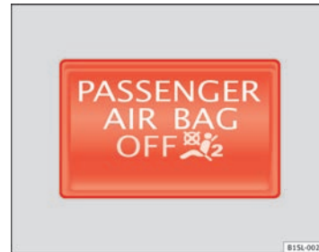
Abb. 46 Kontrollleuchte in der Instrumententafel für abgeschalteten Beifahrer-Frontairbag.
