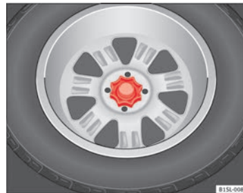
Abb. 123 Im Gepäckraum: Handrad zur Befestigung des Reserverads. ▶
