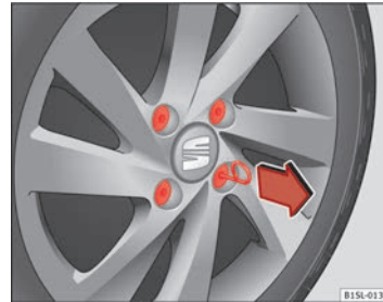
Abb. 140 Abdeckkappen von den Radschrauben abziehen.
