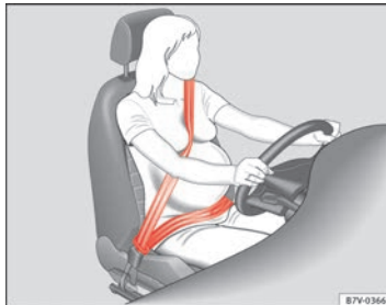
Abb. 45 Richtiges Gurtbandverlauf bei schwangeren Frauen.
