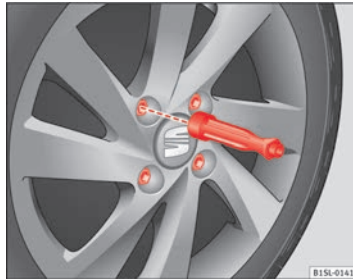
Abb. 145 Radwechsel: Radschrauben mit dem Schraubendrehergriff ab-schrauben.
