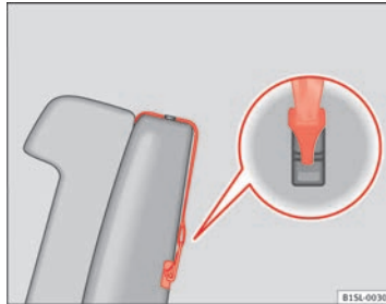
Abb. 54 Beispiel eines eingehängten oberen Befestigungsgurts.
