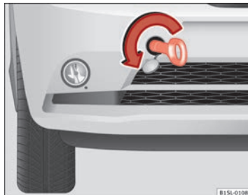
Abb. 162 Im Stoßfänger vorn rechts: Abschleppöse einschrauben.
