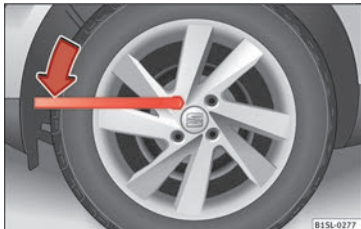
Abb. 53 Radwechsel: Radschrauben lockern.
