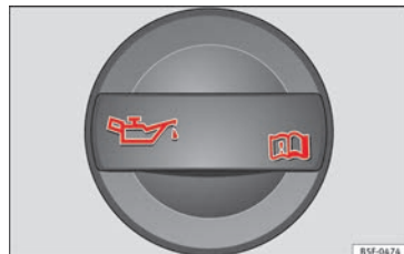
Abb. 169 Im Motorraum: Deckel der Motoröleinfüllöffnung.
