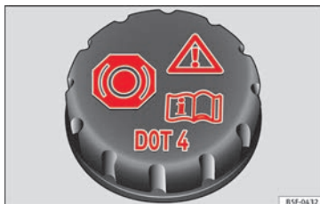
Abb. 43 Motorraum: Deckel des Bremsflüssigkeitsbehälters
