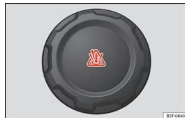
Abb. 42 Motorraum: Deckel des Motorkühlmittelausgleichsbehälters
