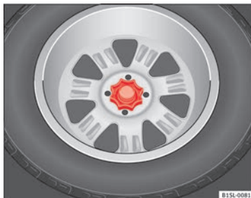
Abb. 177 Im Gepäckraum: Handrad zur Befestigung des Reserverads.
