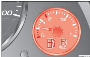
Abb. 165 Im Kombiinstrument: Kraftstoffvorratsanzeige für Benzin und Erdgas.
