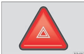
Abb. 31 Instrumententafel: Schalter für die Warnblinkanlage
