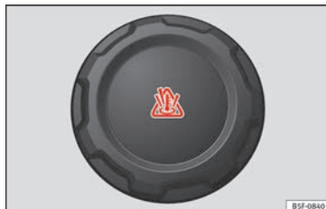
Abb. 171 Im Motorraum: Deckel des Kühlmittelausgleichsbehälters.
