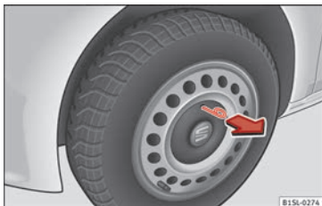
Abb. 50 Radmittenblende an der Stahlfelge abziehen.
