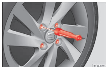
Abb. 57 Radwechsel: Radschrauben mit dem Schraubendrehergriff abschrauben.
