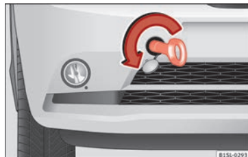
Abb. 81 Im Stoßfänger vorn rechts: Abschleppöse einschrauben.
