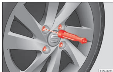
Abb. 57 Radwechsel: Radschrauben mit dem Schraubendrehergriff abschrauben.
