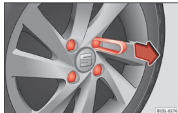
Abb. 52 Abdeckkappen von den Radschrauben abziehen.
