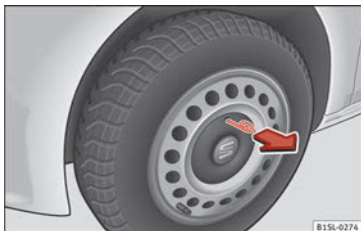
Abb. 50 Radmittenblende an der Stahlfelge abziehen.
