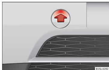
Abb. 80 Im Stoßfänger vorn rechts: Abdeckung abnehmen.
