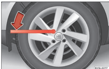
Abb. 53 Radwechsel: Radschrauben lockern.
