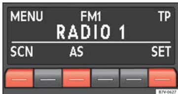
Abb. 10 MENÜ Zusatzfunktionen im Radio-Betrieb: Automatische Sendersuche (SCN), Autostore (AS) und Setup (SET).
