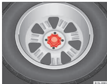
Abb. 176 Im Gepäckraum: Handrad zur Befestigung des Reserverads.
