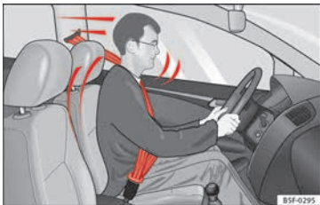
Abb. 69 Richtig angegurte Fahrer werden bei einem plötzlichen Bremsmanöver nicht nach vorne geschleudert.
