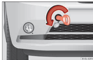
Abb. 58 Vorderer Stoßfänger rechts: Eingeschraubte Abschleppöse
