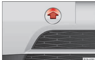
Abb. 80 Im Stoßfänger vorn rechts: Abdeckung abnehmen.
