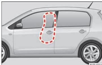
Abb. 22 Auf der linken Fahrzeugseite: Entfaltungsbereich des Seitenairbags.
