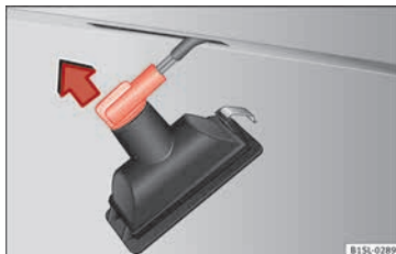
Abb. 91 Kennzeichenleuchte: Lampenträger ausbauen.
