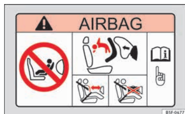
Abb. 23 Sonnenblende auf der Beifahrerseite: Airbagaufkleber.
