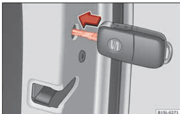
Abb. 5 Notverriegelung des Fahrzeugs mit dem Fahrzeugschlüssel.
