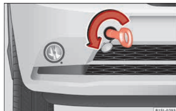
Abb. 81 Im Stoßfänger vorn rechts: Abschleppöse einschrauben.
