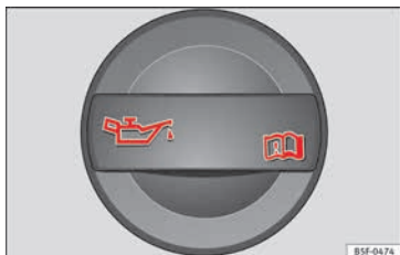
Abb. 41 Deckel der Motoröl-Einfüllöffnung im Motorraum
