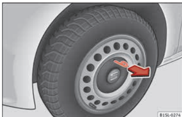
Abb. 50 Radmittenblende an der Stahlfelge abziehen.
