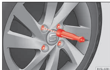
Abb. 57 Radwechsel: Radschrauben mit dem Schraubendrehergriff abschrauben.
