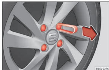
Abb. 52 Abdeckkappen von den Radschrauben abziehen.
