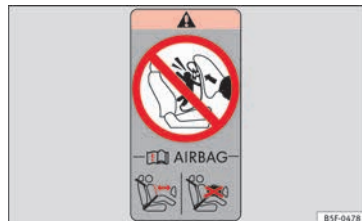
Abb. 24 Im hinteren Rahmen der Beifahrertür: Aufkleber mit Angaben zum Airbag.
