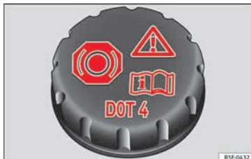
Abb. 43 Motorraum: Deckel des Bremsflüssigkeitsbehälters
