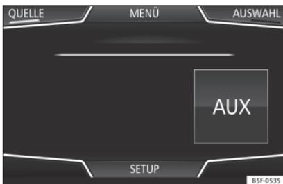
**Abb. 28** Media-Betrieb: Externe Audioquelle über AUX-IN-Buchse angeschlossen.
