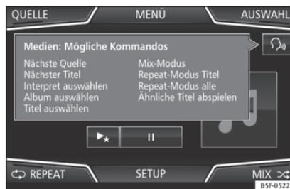
Abb. 6 Sprachbedienung: Anzeige des Startmenüs und wichtigste Befehle
