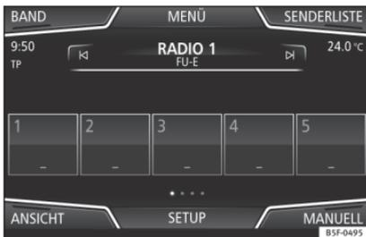
**Abb. 11** Anzeige der Stationstasten im DAB-Betrieb.
