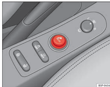
Abb. 99 Der Zigarettenanzünder befindet sich in der Steckdose der vorderen Mittelkonsole
