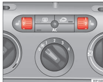
Abb. 91 Rändelräder für die Sitzheizung der Vordersitze
