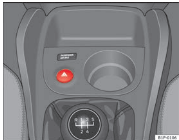
Abb. 75 In der Instrumententafel: Schalter für Warnblinkanlage
