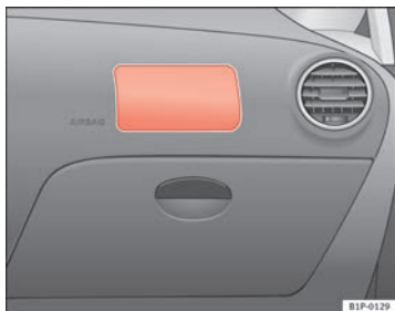
Abb. 18 Einbauort Beifahrerairbag: in der Instrumententafel
