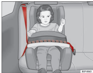
Abb. 28 In Fahrtrichtung eingebauter Kindersitz der Gruppe 1 auf dem Rücksitz
