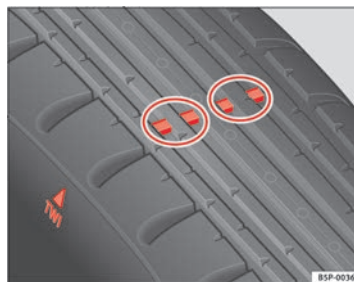
Abb. 152 Prinzipdarstellung Reifenprofil: Verschleißanzeiger
