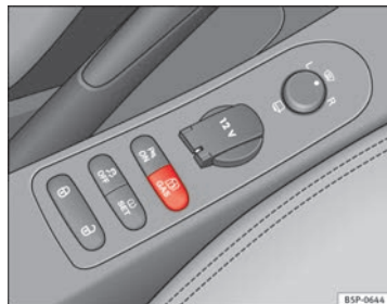
Abb. 118 Mittelkonsole: Kontrollschalter für Autogasanlage.
