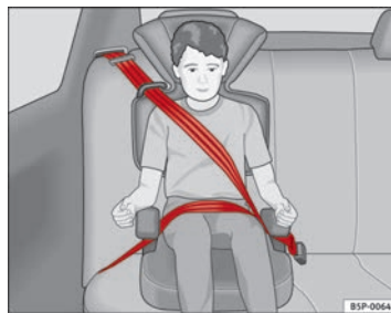
Abb. 29 In Fahrtrichtung eingebauter Kindersitz auf dem Rücksitz
