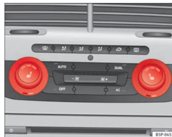
Abb. 92 Sitzheizung der Vordersitze mit Climatronic
