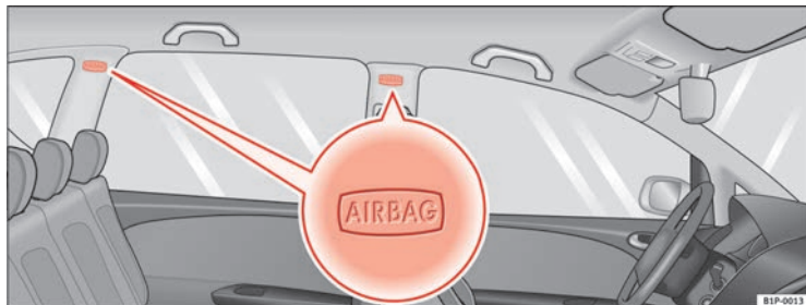
Abb. 23 Einbauort der Kopfairbags auf der linken Fahrzeugseite
