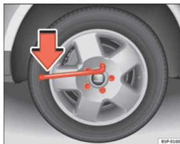
Abb. 156 Radwechsel: Radschrauben lockern
