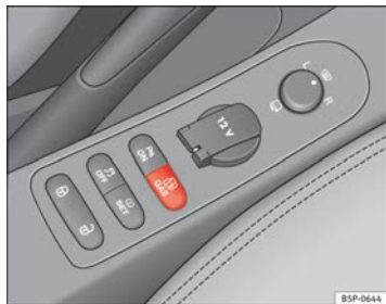
Abb. 118 Mittelkonsole: Kontrollschalter für Autogasanlage.
