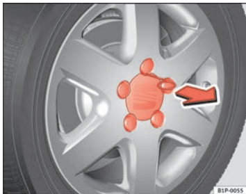
Abb. 155 Radwechsel: Radzierkappe abziehen
