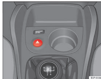
Abb. 75 In der Instrumententafel: Schalter für Warnblinkanlage
