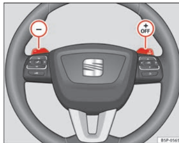
Abb. 129 Lenkrad mit Wippen für Automatikgetriebe
