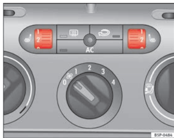
Abb. 92 Rändelräder für die Sitzheizung der Vordersitze
