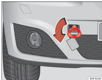
Abb. 183 Frontpartie rechts: Einschrauben der vorderen Abschleppöse
