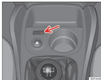
Abb. 26 Kontrollleuchte für Abschaltung der Beifahrerairbags
