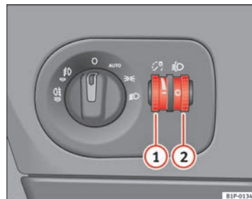
Abb. 74 In der Instrumententafel: Regler für die Instrumenten-/Schalterbeleuchtung und Leuchtweitenregulierung
