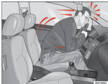
Abb. 8 Der nicht angegurte Fahrer fliegt nach vorne
