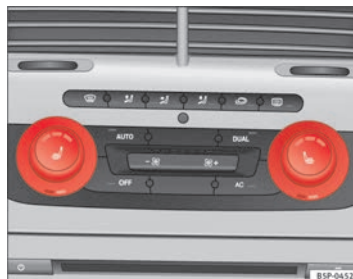
Abb. 93 Sitzheizung der Vordersitze mit Climatronic
