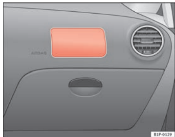
Abb. 18 Einbauort Beifahrerairbag: in der Instrumententafel
