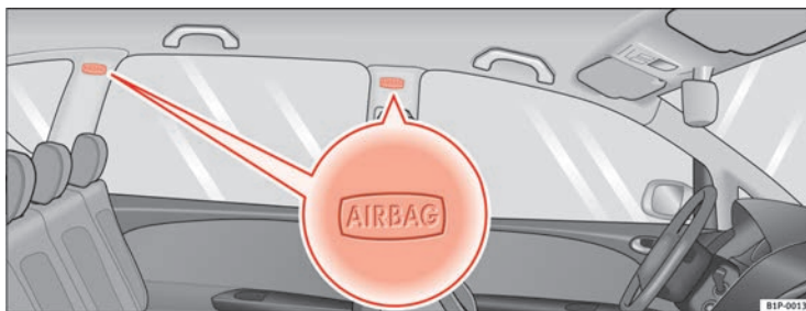
Abb. 23 Einbauort der Kopfairbags auf der linken Fahrzeugseite
