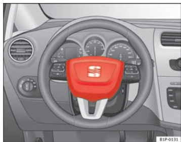
Abb. 17 Einbauort Fahrerairbag: im Lenkrad
