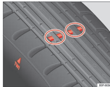
Abb. 153 Prinzipdarstellung Reifenprofil: Verschleißanzeiger
