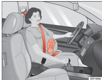
Abb. 14 Gurtbandverlauf bei schwangeren Frauen
