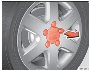
Abb. 156 Radwechsel: Radzierkappe abziehen
