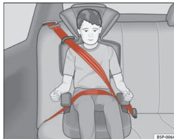
Abb. 29 In Fahrtrichtung eingebauter Kindersitz auf dem Rücksitz
