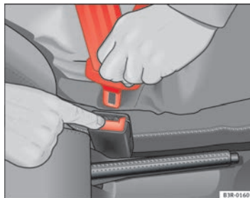
Abb. 15 Lösen der Schlosszunge vom Gurtschloss
