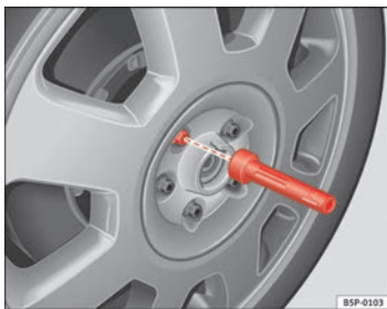
Abb. 160 Radwechsel: Innensechskant zum Drehen der Schrauben
