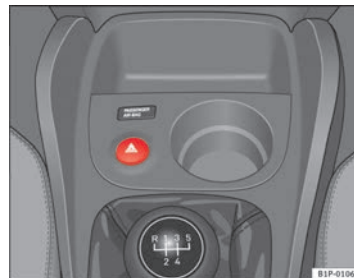
Abb. 76 In der Instrumententafel: Schalter für Warnblinkanlage
