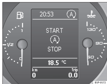
Abb. 121 Anzeige am Display des Kombiinstrumentes während des Start-Stop-Betriebs
