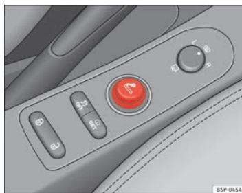
Abb. 100 Der Zigarettenanzünder befindet sich in der Steckdose der vorderen Mittelkonsole
