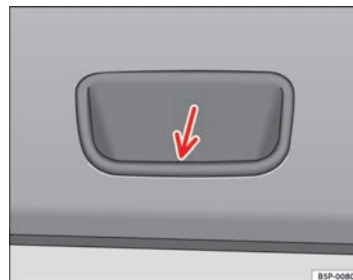
Abb. 66 Ausschnitt aus Innenverkleidung der Gepäckraumklappe: Griff- mulde zum Zuziehen
