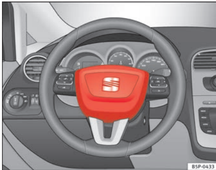
Abb. 17 Einbauort Fahrerairbag: im Lenkrad
