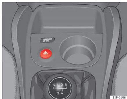
Abb. 75 In der Instrumententafel: Schalter für Warnblinkanlage
