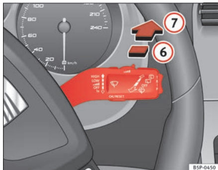
Abb. 84 Scheibenwischer- und Scheibenwaschhebel: Heckscheibenwischer
