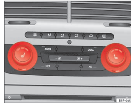
Abb. 92 Sitzheizung der Vordersitze mit Climatronic
