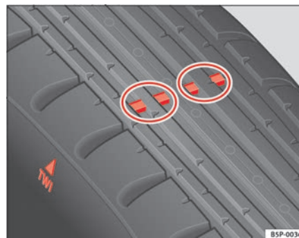
Abb. 147 Prinzipdarstellung Reifenprofil: Verschleißanzeiger
