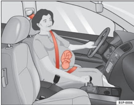
Abb. 14 Gurtbandverlauf bei schwangeren Frauen
