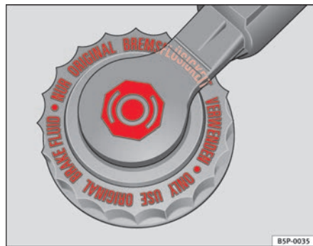
Abb. 146 Im Motorraum: Abdeckung des Bremsflüssigkeitsbehälters
