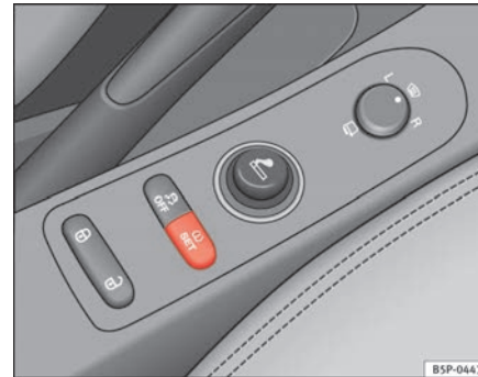
Abb. 48 Mittelkonsole: Taste für die Reifen- Kontroll-Anzeige
