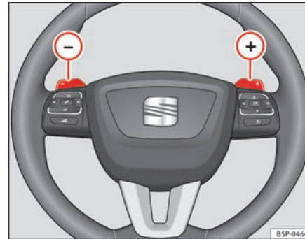
Abb. 126 Lenkrad mit Wippen für Automatikgetriebe
