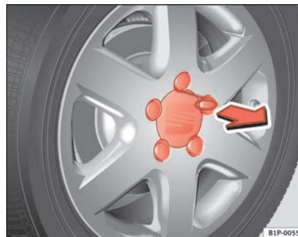
Abb. 150 Radwechsel: Radzierkappe abziehen
