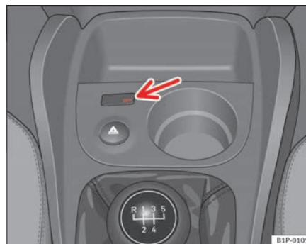
Abb. 26 Kontrollleuchte für Abschaltung der Beifahrerairbags
