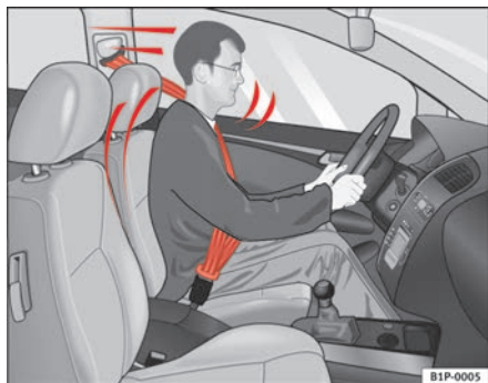
Abb. 10 Fahrer mit einem korrekt angelegten Sicherheitsgurt: er wird bei einer Vollbremsung durch den Gurt gesichert
