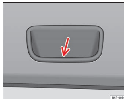
Abb. 65 Ausschnitt aus Innenverkleidung der Gepäckraumklappe: Griff- mulde zum Zuziehen
