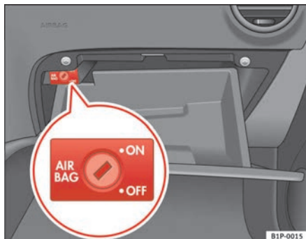
Abb. 25 Im Handschuhfach: Schlüsselschalter zum An- und Abschalten des Beifahrerairbags.
