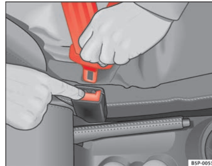
Abb. 15 Lösen der Schlosszunge vom Gurtschloss
