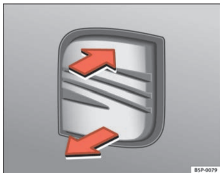
Abb. 64 Heckklappe: Öffnen von außen
