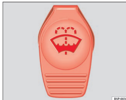
Abb. 142 Im Motorraum: Deckel des Scheiben- waschwasserbehälters
