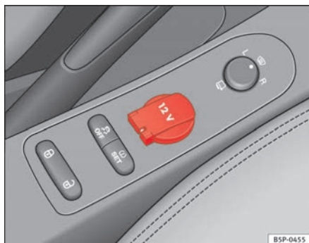
Abb. 101 Steckdose Mittelkonsole vorne
