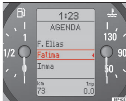
Abb. 6 Telefonbuch am Schalttafeleinsatz
