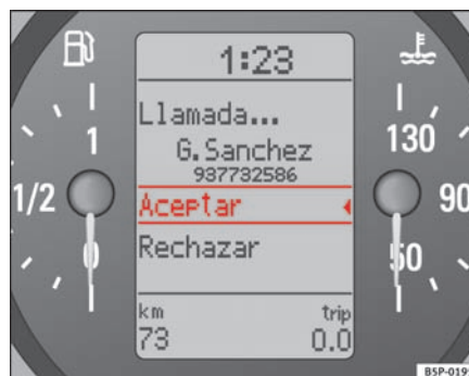
Abb. 7 Ankommender Anruf am Schalttafeleinsatz
