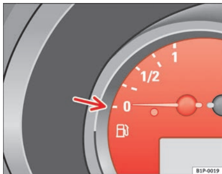
Abb. 33 Ausschnitt aus Kombiinstrument: Kraftstoffvorrats-Anzeige
