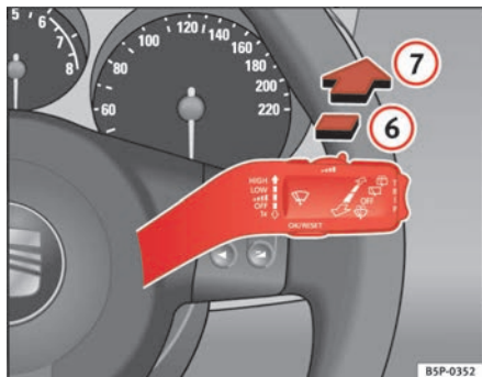
Abb. 85 Scheibenwischer- und Scheibenwascherhebel: Scheibenwischer für die Heckscheibe
