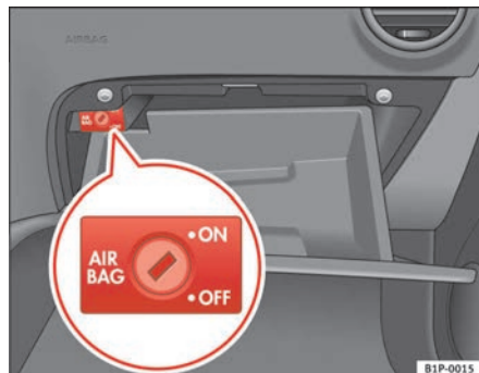
Abb. 25 Im Handschuhfach: Schlüsselschalter zum Ein- und Abschalten des Beifahrer-Airbags
