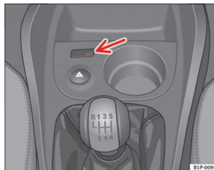
Abb. 26 Kontrollleuchte für Abschaltung der Beifahrerairbags
