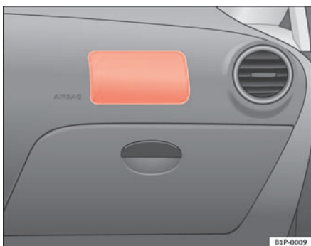
Abb. 18 Einbauort Beifahrerairbag: in der Instrumententafel
