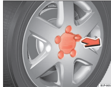
Abb. 154 Radwechsel: Radzierkappe abziehen
