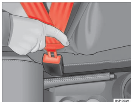
Abb. 11 Gurtschloss und Schloßzunge des Sicherheitsgurtes
