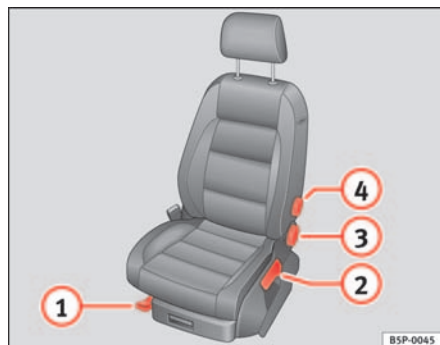
Abb. 90 Bedienelemente am linken Vordersitz
