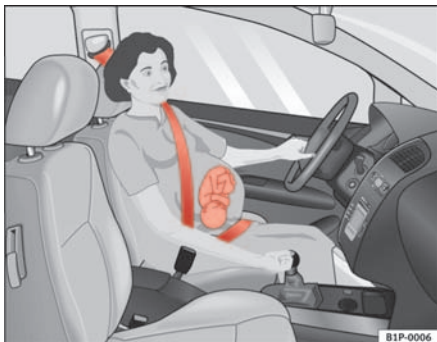
Abb. 14 Gurtbandverlauf bei schwangeren Frauen
