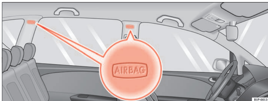
Abb. 23 Einbauort der Kopfairbags auf der linken Fahrzeugseite
