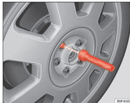
Abb. 158 Radwechsel: Innensechskant zum Drehen der Schrauben
