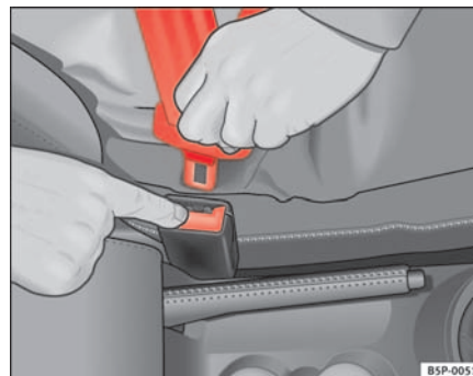
Abb. 15 Lösen der Schlosszunge vom Gurtschloss
