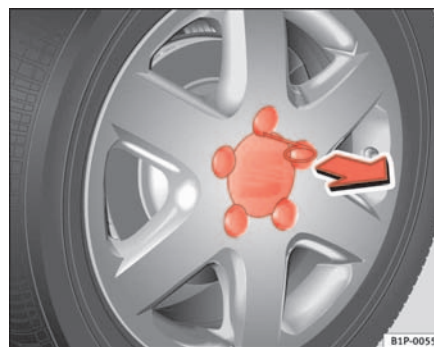
Abb. 147 Radwechsel: Radzierkappe abziehen
