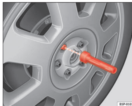
Abb. 151 Radwechsel: Innensechskant zum Drehen der Schrauben
