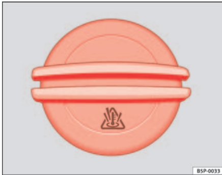
Abb. 139 Im Motorraum: Deckel des Kühlmittel-Ausgleichsbehälters
