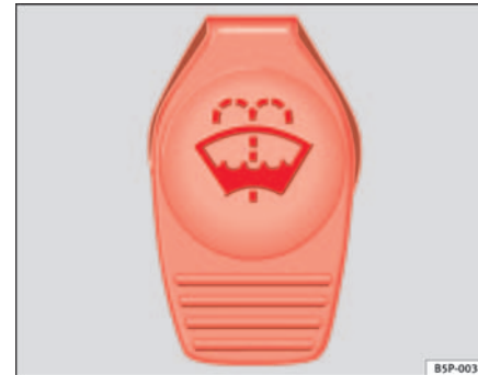
Abb. 140 Im Motorraum: Deckel des Scheiben- waschwasserbehälters
