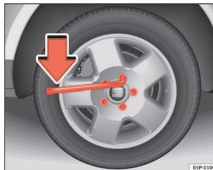
Abb. 148 Radwechsel: Radschrauben lockern
