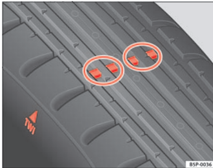
Abb. 144 Prinzipdarstellung Reifenprofil: Verschleißanzeiger
