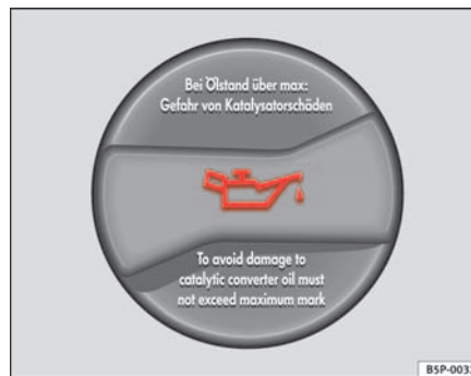
Abb. 138 Deckel der Motoröl-Einflüllöffnung im Motorraum
