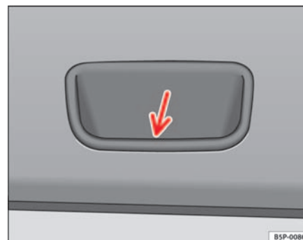
Abb. 67 Ausschnitt aus der Innenverkleidung Heckklappe: Griffmulde zum Zuziehen
