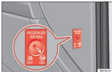
Abb. 23 Schalter für Beifahrer-Frontairbag.
