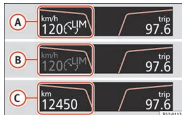
Abb. 188 Im Display des Kombiinstruments: Anzeige des Zustands des Geschwindigkeitsbegrenzers.
