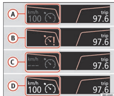
Abb. 187 Display des Kombiinstruments: Zustandsanzeigen der GRA.
