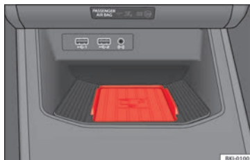
Abb. 134 Mittelkonsole: Connectivity Box
