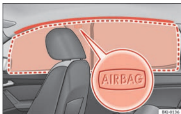
Abb. 27 Einbauort und Entfaltungsbereich des Kopfairbags.
