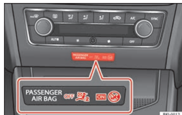
Abb. 106 Instrumententafel-Mittelteil: Kontrollleuchte für abgeschalteten Beifahrer-Frontairbag.
