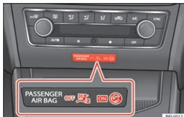
Abb. 24 Instrumententafel-Mitteil: Kontrollleuchte für abgeschalteten Beifahrer-Frontairbag.
