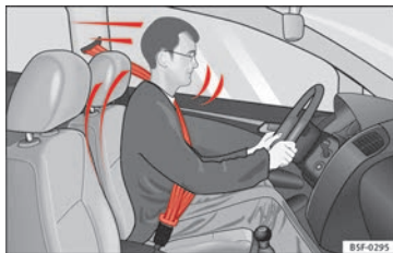
Abb. 100 Richtig angegurtete Fahrer werden bei einem plötzlichen Bremsmanöver nicht nach vorne geschleudert.
