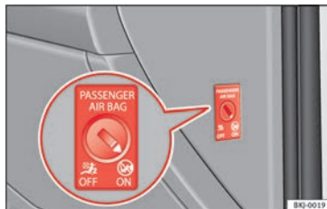
Abb. 105 Schlüsselschalter zum Ein- und Abschalten des Beifahrerairbags.
