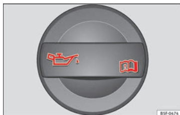
Abb. 67 Deckel der Motoröl-Einfüllöffnung im Motorraum
