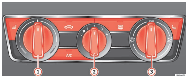
Abb. 175 Bedienelemente Klimaanlage in der Instrumententafel.
