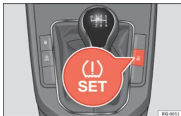
Abb. 234 Mittelkonsole: Taste für die Reifenkontrollanzeige
