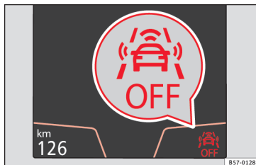
Abb. 193 Auf dem Display des Kombi-Instruments: Anzeige, dass Front Assist ausgeschaltet ist.
