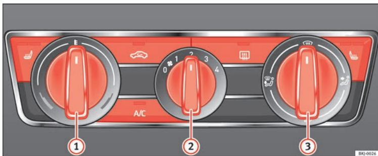
Abb. 63 In der Mittelkonsole: Bedienelemente der manuellen Klimaanlage.
