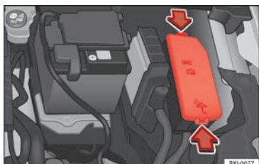
Abb. 72 Im Motorraum: Abdeckung des Sicherungskastens.
