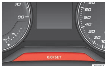
Abb. 126 Kombi-Instrument: Kilometerzähler und Rückstelltaste.
