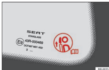
Abb. 98 Warnschild für Kopfstützenstellung
