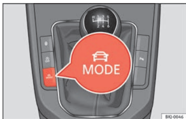
Abb. 203 Neben dem Schalthebel: Taste MODE.
