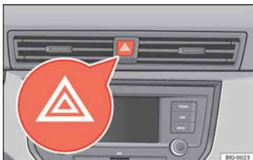
Abb. 42 Instrumententafel: Schalter für die Warnblinkanlage
