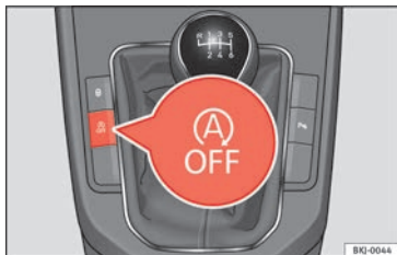
Abb. 186 Mittelkonsole: Systemtaste Start-Stopp.
