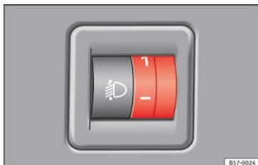
Abb. 150 Instrumententafel: Regler für Leuchtweitenregulierung.
