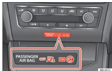
Abb. 57 Kontrolllampchen für Abschaltung des und Beifahrerairbags.
