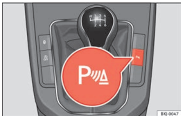
Abb. 207 Mittelkonsole: Taste für Einparkhilfe.
