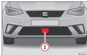
Abb. 192 Im vorderen Stoßfänger: Radarsensor.
