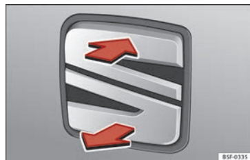
Abb. 6 Heckklappe: Öffnen von außen
