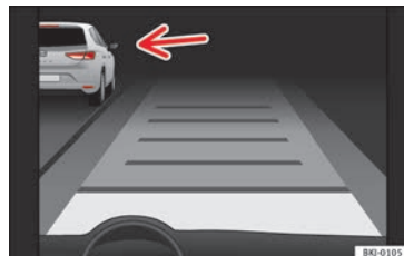
Abb. 200 Im Display des Kombiinstrument: ACC aktiv, Fahrzeug auf der linken Seite erkannt
