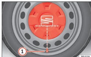
Abb. 78 Korrekte Anbringung der Radvollblende für Stahlfelgen.
