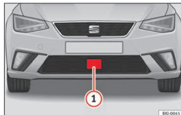
Abb. 197 Im vorderen Stoßfänger: Radarsensor.
