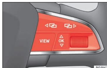
Abb. 48 Rechte Seite Multifunktions-Lenkrad: Steuertasten.
