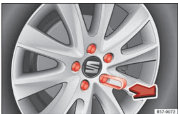
Abb. 82 Rad: Radschrauben mit Deckel.
