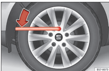
Abb. 83 Radwechsel: Radschrauben lockern
