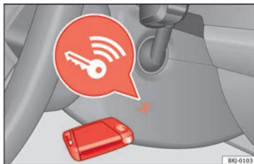
Abb. 179 Rechts an der Lenksäule: Notstart.
