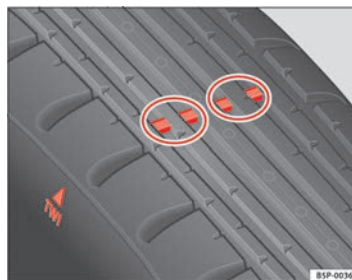
Abb. 129 Prinzipdarstellung Reifenprofil: Verschleißanzeiger
