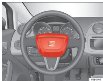
Abb. 16 Einbauort Fahrerairbag: im Lenkrad
