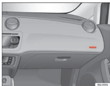
Abb. 17 Einbauort Beifahrerairbag: in der Instrumententafel
