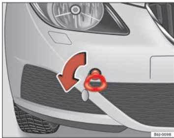
Abb. 160 Einschrauben der Abschleppöse vorne am Fahrzeug
