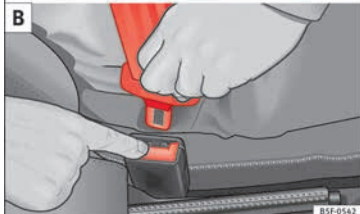
Abb. 13 Schloßzunge des Sicherheitsgurts in das Gurtschloß einstecken und vom Gurtschloß lösen.
