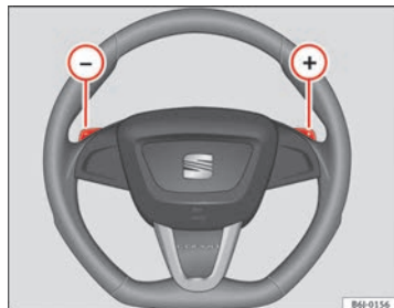
Abb. 109 Lenkrad mit Schaltwippen für Automatikgetriebe
