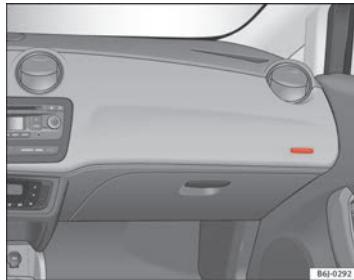
Abb. 17 Einbautort Beifahrerairbag: in der Instrumententafel
