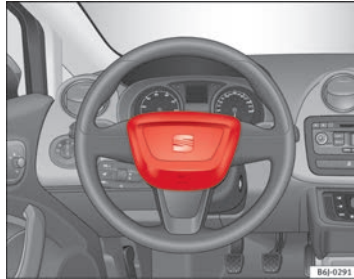
Abb. 16 Einbautort Fahrerairbag: im Lenkrad
