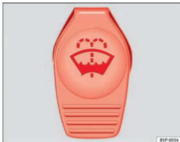
Abb. 128 Im Motorraum: Deckel des Scheibenwaschwasserbehälters
