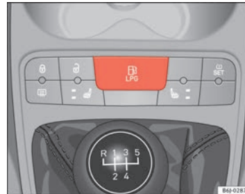
Abb. 100 Mittelkonsole: Kontrollschalter für Autogasanlage.
