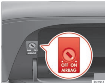
Abb. 21 Im Handschuhfach: Schüsselschalter zum Ein- und Abschalten des Beifahrer-Airbags
