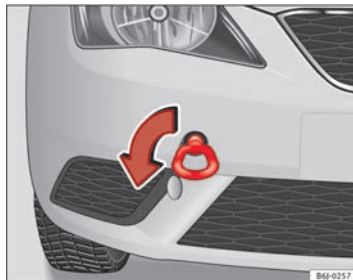
Abb. 170 Einschrauben der Abschleppöse vorne am Fahrzeug
