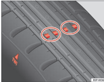
Abb. 134 Prinzipdarstellung Reifenprofil: Verschleißanzeiger
