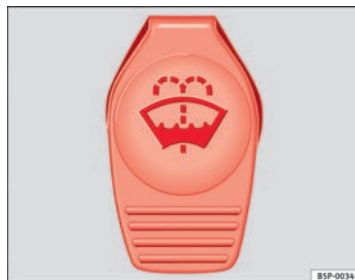
Abb. 128 Im Motorraum: Deckel des Scheibenwaschwasserbehälters
