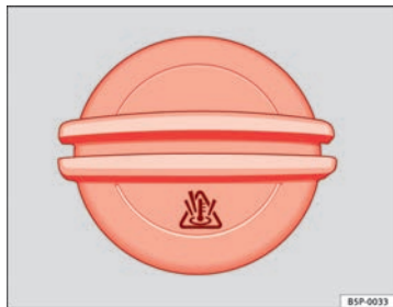
Abb. 127 Im Motorraum: Deckel des Kühlmittel- Ausgleichsbehälters
