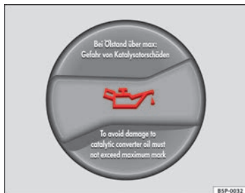
Abb. 126 Deckel der Motoröl-Einfüllöffnung im Motorraum
