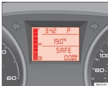
Abb. 36 Display: Wählhebelstellung des Automatikgetriebes
