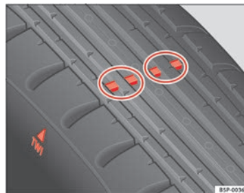
Abb. 134 Prinzipdarstellung Reifenprofil: Verschleißanzeiger
