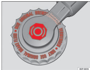
Abb. 133 Im Motorraum: Abdeckung des Bremsflüssigkeitsbehälters
