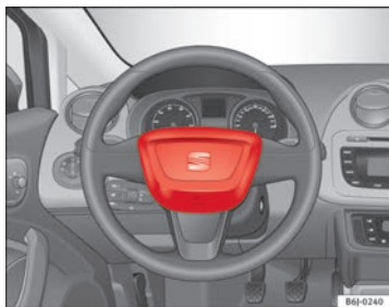
Abb. 16 Einbauort Fahrerairbag: im Lenkrad
