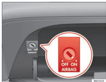
Abb. 21 Im Handschuhfach: Schlüsselschalter zum An- und Abschalten des Beifahrerairbags.
