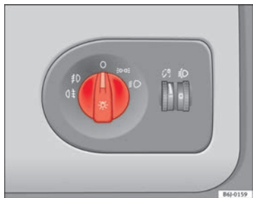
Abb. 54 Ausschnitt aus der Instrumententafel: Schalter für die Leuchten, Nebelscheinwerfer und Nebelschlussleuchte
