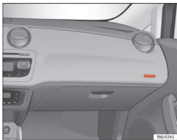
Abb. 17 Einbauort Beifahrerairbag: in der Instrumententafel
