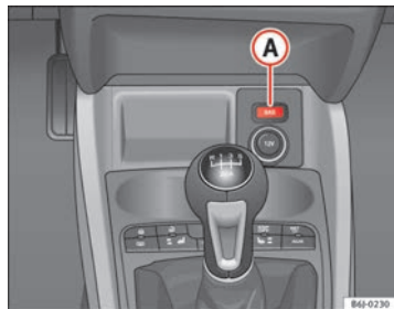
Abb. 100 Mittelkonsole: Kontrollschalter für Autogasanlage.
