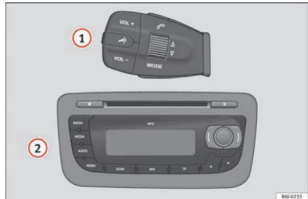
Abb. 1 Anzeige- und Bedienelemente des Bluetooth-Systems
