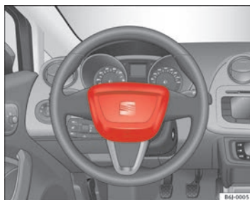
Abb. 16 Einbauort Fahrerairbag: im Lenkrad
