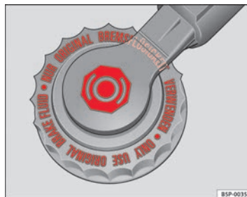
Abb. 124 Im Motorraum: Abdeckung des Bremsflüssigkeitsbehälters
