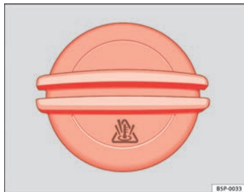
Abb. 120 Im Motorraum: Deckel des Kühlmittel- Ausgleichsbehälters
