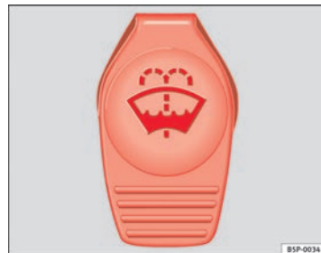
Abb. 121 Im Motorraum: Deckel des Scheibenwaschwasserbehälters
