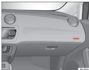
Abb. 17 Einbauort Beifahrerairbag: in der Instrumententafel
