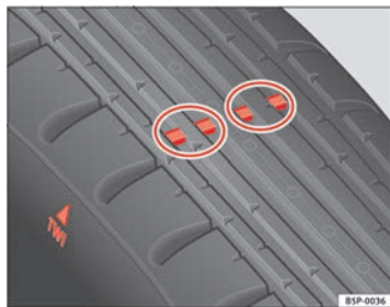
Abb. 125 Prinzipdarstellung Reifenprofil: Verschleißanzeiger
