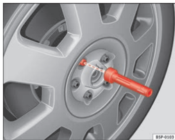
Abb. 131 Radwechsel: Innensechskant zum Drehen der Schrauben
