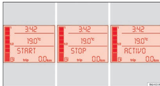
Abb. 98 Anzeige am Display des Kombiinstruments während des Start-Stopp-Betriebs
