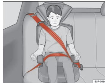
Abb. 27 In Fahrtrichtung eingebauter Kindersitz auf dem Rücksitz
