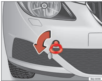
Abb. 152 Einschrauben der Abschleppöse vorne am Fahrzeug
