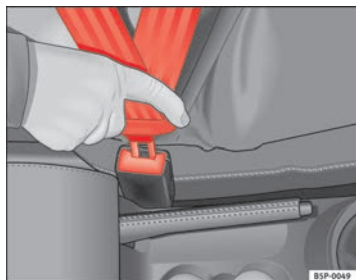
Abb. 11 Gurtschloss und Schloßzunge des Sicherheitsgurtes
