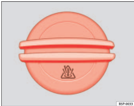
Abb. 129 Im Motorraum: Deckel des Kühlmittel- Ausgleichsbehälters
