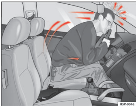
Abb. 8 Der nicht angegurte Fahrer fliegt nach vorne
