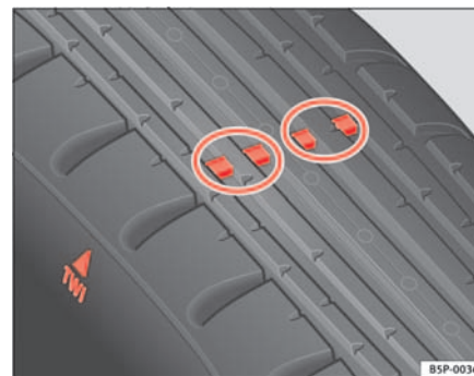
Abb. 134 Prinzipdarstellung Reifenprofil: Verschleißanzeiger ▶
