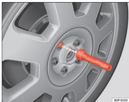
Abb. 144 Radwechsel: Innensechskant zum Drehen der Schrauben
