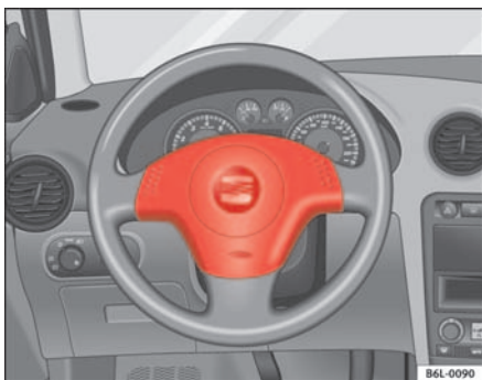
Abb. 16 Einbauort Fahrerairbag: im Lenkrad
