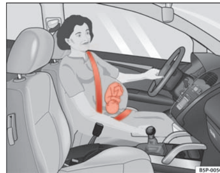
Abb. 14 Gurtbandverlauf bei schwangeren Frauen ▶
