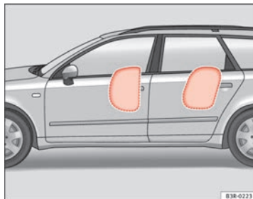
Abb. 24 Aufgeblasener Seitennairbag auf der linken Fahrzeugseite
