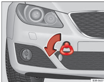
Abb. 242 Einschrauben der Abschleppöse vorne am Fahrzeug
