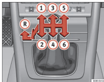
Abb. 153 Ansicht der Mittelkonsole: Schalt-schema eines 6-Gang-Schaltgetriebes
