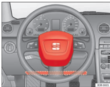
Abb. 17 Fahrerairbag im Lenkrad und Knieairbag in der Instrumententafel
