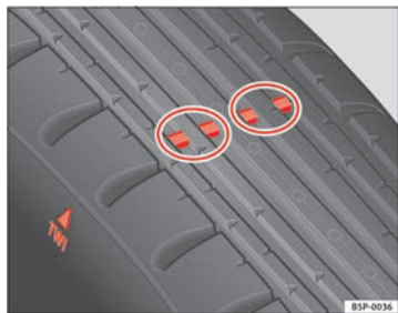
Abb. 187 Prinzipdarstellung Reifenprofil: Verschleißanzeiger
