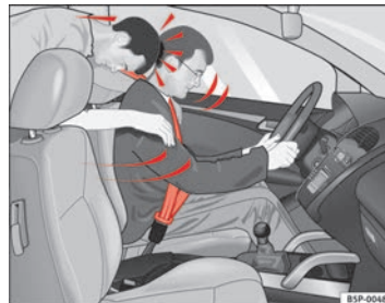
Abb. 10 Der nicht angegurte Mitfahrer auf dem Rücksitz wird nach vorne auf den angegurten Fahrer geschleudert.
