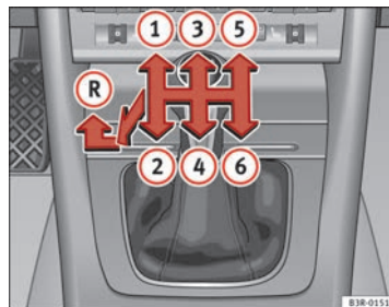
Abb. 146 Ausschnitt aus der Mittelkonsole: Schaltschema des 6-Gang-Schaltgetriebes
