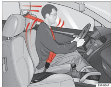
Abb. 11 Angegurter Fahrer, der bei einem plötzlichem Bremsmanöver vom richtig angelegten Sicherheitsgurt aufgefangen wird
