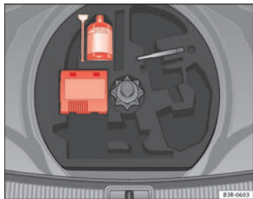
Abb. 181 Reifenreparaturset (Tire-Mobility-System) unter Ladeboden im Gepäckraum
