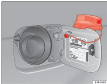
Abb. 167 Tankklappe mit aufgestecktem Tankverschluss
