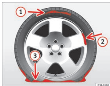
Abb. 184 Reifenschäden für die das Tire-Mobility-System nicht geeignet ist
