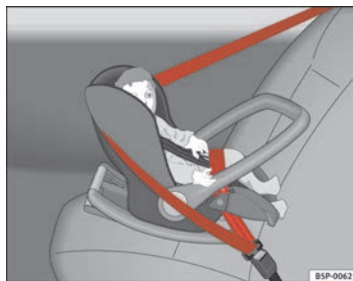
Abb. 29 Entgegen der Fahrtrichtung eingebauter Kindersitz der Gruppe 0 auf dem Rücksitz
