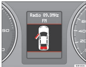
Abb. 51 Display: Tür- und Gepäckraumklappenwarnung
