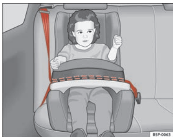
Abb. 30 In Fahrtrichtung eingebauter Kindersitz der Gruppe 1 auf dem Rücksitz
