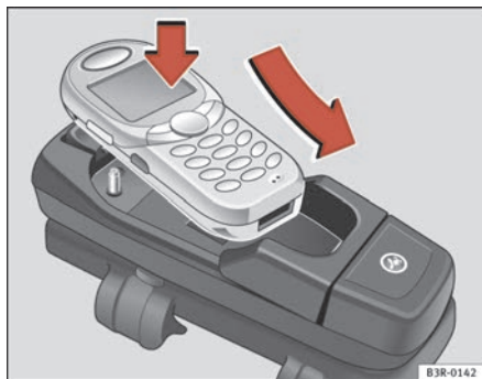
Abb. 13 Mobiltelefon in den Mobiltelefon-Adapter einsetzen
