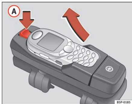
Abb. 14 Mobiltelefon aus dem Mobiltelefon-Adapter herausnehmen
