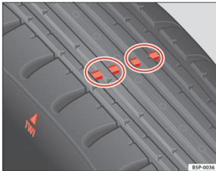
Abb. 129 Prinzipdarstellung Reifenprofil: Verschleißanzeiger
