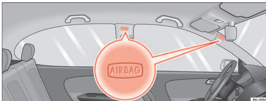
Abb. 23 Einbauort der Kopfairbags auf der linken Fahrzeugseite
