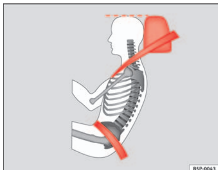
Abb. 4 Richtig eingestellte Kopfstütze von der Seite betrachtet
