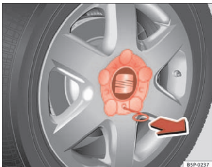
Abb. 129 Radwechsel: Radzierkappe abziehen
