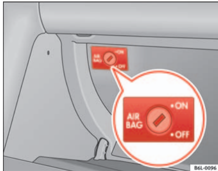
Abb. 25 Im Handschuhkasten: Schüsselschalter zum Ab- und Einschalten der Airbags auf der Beifahrerseite
