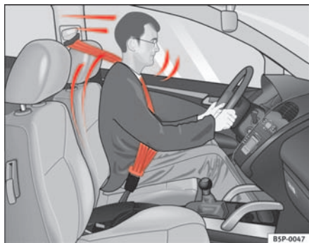
Abb. 10 Angegurter Fahrer, der bei einem plötzlichem Bremsmanöver vom richtig angelegten Sicherheitsgurt aufgefangen wird
