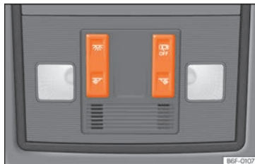
Abb. 111 Ausschnitt aus Dachhimmel:: Innenraumbeleuchtung vorn.
