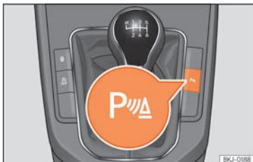
Abb. 254 Mittelkonsole: Taste für Einparkhilfe (je nach Ausführung).
