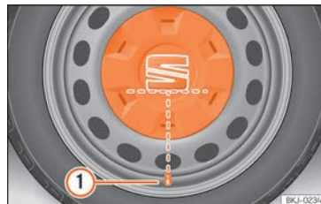
Abb. 34 Korrekte Anbringung der Radvollblende für Stahlfelgen.
