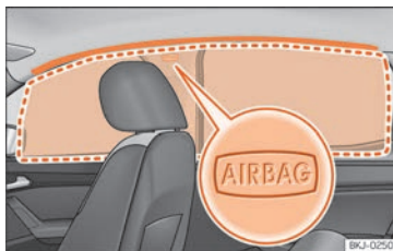
Abb. 21 Einbauort und Entfaltungsbereich des Kopfairbags.
