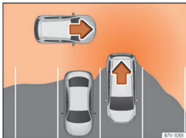
Abb. 244 Schematische Abbildung des Ausparkassistenten: Überwachter Bereich des ausparkenden Fahrzeugs.
