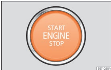
Abb. 209 Im unteren Teil der Mittelkonsole: Starterknopf.
