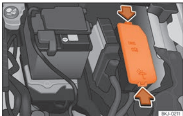
Abb. 51 Im Motorraum: Abdeckung des Sicherungskastens.
