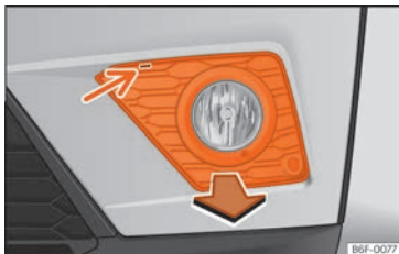
Abb. 57 Nebelscheinwerfer: Gitter herausziehen
