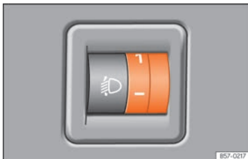
Abb. 109 Neben dem Lenkrad: Regler für die Leuchtweitenregulierung.
