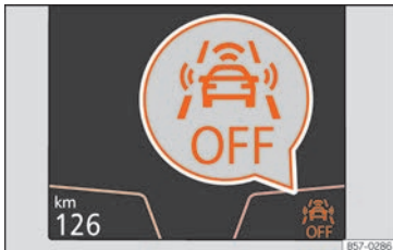
Abb. 229 Am Bildschirm des Kombi-Instruments: Anzeige, dass Front Assist ausgeschaltet ist.
