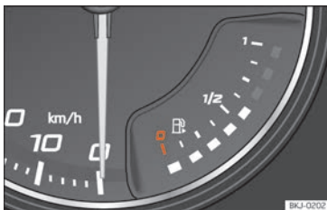
Abb. 73 Analoges Kombi-Instrument: Kraftstoffvorratsanzeige
