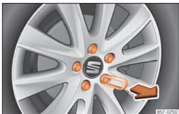
Abb. 35 Rad: Radschrauben mit Deckel.
