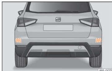
Abb. 241 Heckansicht des Fahrzeugs: Bereiche der Radarsensoren.
