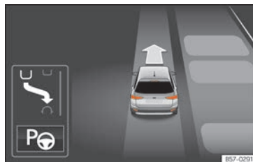
Abb. 248 Am Bildschirm des Kombi-Instruments: Anzeige des Parklenkassistenten in eingeschränkter Sicht.
