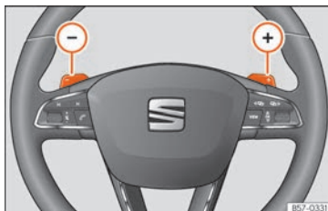
Abb. 216 Lenkrad: Hebel für Automatikgetriebe.
