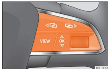
Abb. 79 Rechte Seite des Multifunktionslenkrads: Bedienelemente für die Menüs und Informationsanzeigen im Kombi-Instrument.
