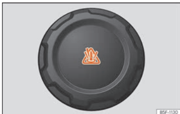
Abb. 285 Motorraum: Deckel des Motorkühlmittelausgleichsbehälters.
