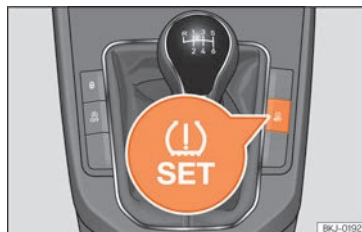
Abb. 291 Mittelkonsole: Taste für die Reifenkontrollanzeige.
