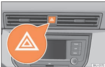
Abb. 108 Instrumententafel: Schalter für Warnblinkanlage.
