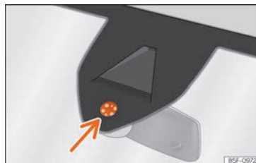
Abb. 114 Sensitive Fläche des Regensensors.
