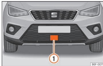
Abb. 228 Am vorderen Stoßfänger: Radarsensor.
