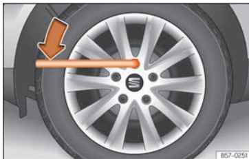
Abb. 37 Radwechsel: Radschrauben lockern.
