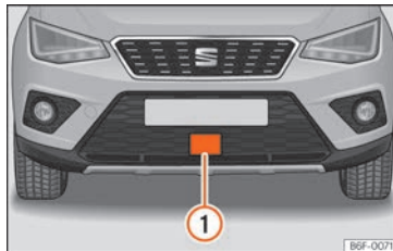
Abb. 234 Am vorderen Stoßfänger: Radarsensor.
