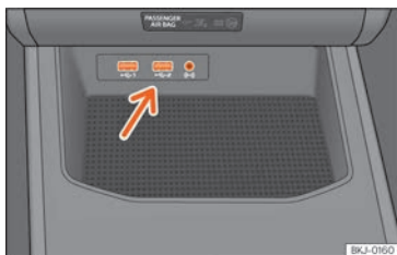
Abb. 205 Mittelkonsole: USB/AUX-IN Anschluss.
