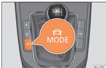
Abb. 219 Neben dem Schalthebel.: Taste MODE .
