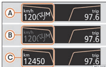
Abb. 224 Am Bildschirm des Kombi-Instruments: Statusanzeigen des Geschwindigkeitsbegrenzers.
