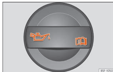
Abb. 283 Deckel der Motoröl-Einfüllöffnung im Motorraum
