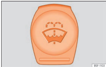
Abb. 287 Im Motorraum: Deckel des Scheibenwaschbehälters.
