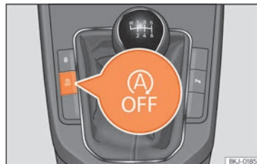
Abb. 212 Mittelkonsole: Taste des Start-Stopp-Systems.
