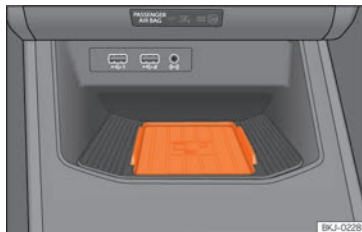
Abb. 207 In der Mittelkonsole: Aufnahme für die Mobiltelefonkopplung.
