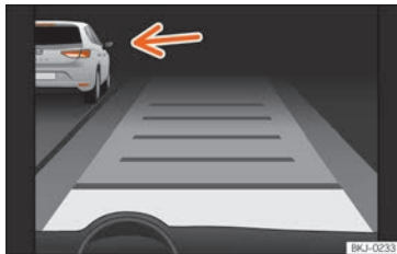
Abb. 237 Am Bildschirm des Kombi-Instruments: ACC aktiv, Fahrzeug auf der linken Seite erkannt
