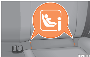
Abb. 4 Kennzeichnung der ISOFIX-Verankerungspunkte für Kindersitze.
