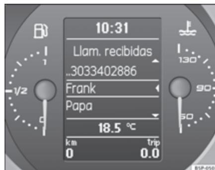
Abb. 5 Beispiel für den angenommenen Anruf am Kombiinstrument
