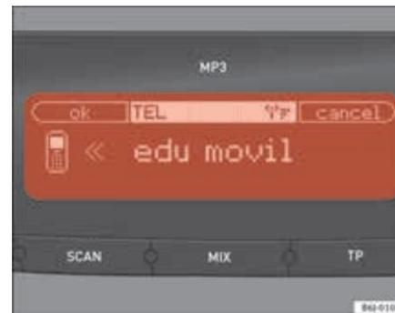
Abb. 12 Beispiel für einen eingehenden Anruf am Radiodisplay
