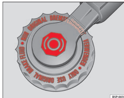
Abb. 170 Im Motorraum: Abdeckung des Bremsflüssigkeitsbehälters
