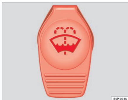
Abb. 166 Im Motorraum: Deckel des Scheiben- waschwasserbehälters
