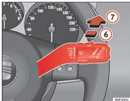
Abb. 88 Scheibenwischer- und Scheibenwascherhebel: Scheibenwischer für die Heckscheibe
