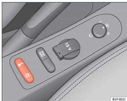
Abb. 60 Ausschnitt der Mittelkonsole: Zentralverriegelungstaster
