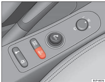
Abb. 48 Mittelkonsole: Taste für die Reifenkontrollanzeige
