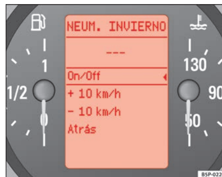
Abb. 46 Display im Kombiinstrument: Anzeige Winterreifen
