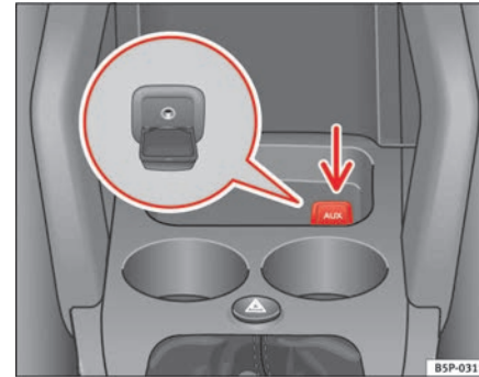
Abb. 118 Anschluss für einen zusätzlichen Audio-Eingang
