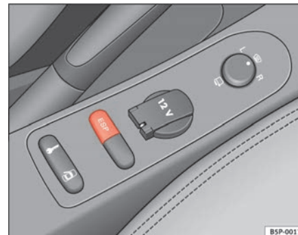
Abb. 134 Ausschnitt aus der Mittelkonsole: ESP-Taste
