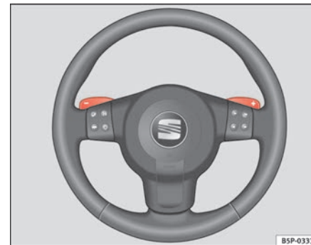
Abb. 143 Lenkrad mit Wippen für Automatikgetriebe
