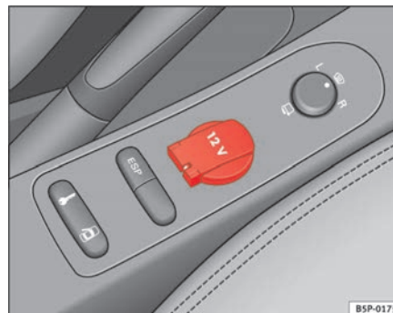
Abb. 117 Steckdose an der Mittelkonsole vorne ▶
