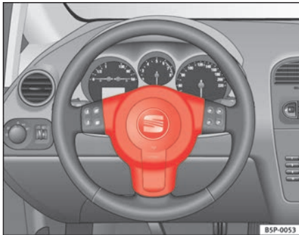
Abb. 18 Einbauort Fahrerairbag: im Lenkrad
