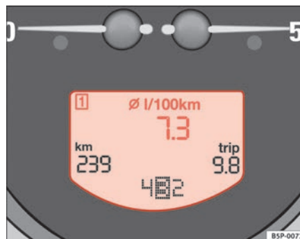
Abb. 42 Display im Kombiinstrument: Anzeige des durchschnittlichen Kraftstoffverbrauchs.
