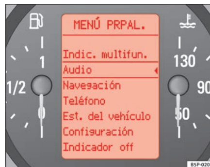
Abb. 44 Display im Kombiinstrument: Hauptmenü
