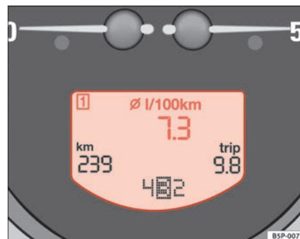
Abb. 40 Display im Kombiinstrument: Anzeige des durchschnittlichen Kraftstoffverbrauchs
