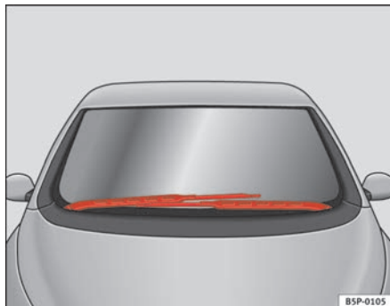
Abb. 167 Scheibenwischer in Service-Stellung
