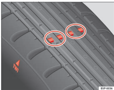
Abb. 171 Prinzipdarstellung Reifenprofil: Verschleißanzeiger
