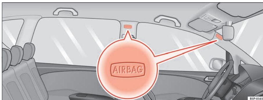
Abb. 24 Einbauort der Kopfairbags auf der linken Fahrzeugseite
