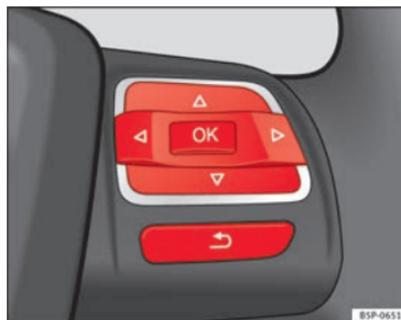
Abb. 3 Tasten am Multifunktionslenkrad rechts
