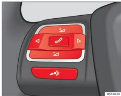
Abb. 2 Tasten am Multifunktionslenkrad links
