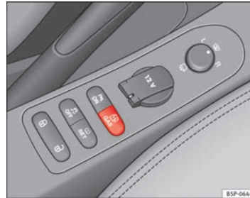
Abb. 136 Mittelkonsole: Kontrollschalter für Autogasanlage.
