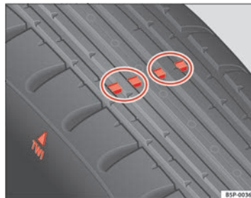
Abb. 171 Prinzipdarstellung Reifenprofil: Verschleißanzeiger
