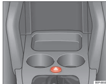
Abb. 77 In der Instrumententafel: Schalter für Warnblinkanlage
