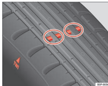
Abb. 173 Prinzipdarstellung Reifenprofil: Verschleißanzeiger
