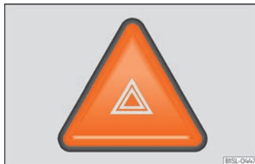
Abb. 117 Instrumententafel: Schalter für Warnblinkanlage.
