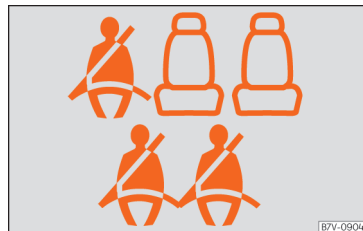
Abb. 6 Beispiel der Gurtstatusanzeige für die hinteren Sitzplätze (hier beim 7-Sitzer) im Kombi-Instrument: oben zweite Sitzreihe, unten dritte Sitzreihe.
