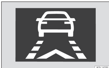
Abb. 246 Am Bildschirm des Kombi-Instruments: Anzeigen der Vorwarnung.
