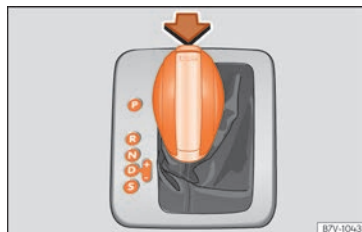
Abb. 238 Wählhebel des automatischen Getriebes mit Sperrtaste (Pfeil).
