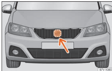
Abb. 251 Im Frontbereich hinter dem SEAT-Emblem: Radarsensor.
