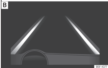
Abb. 257 Am Bildschirm des Kombi-Instruments: Bildschirmanzeige des Spurhalteassistenten [Beispiel 1].
