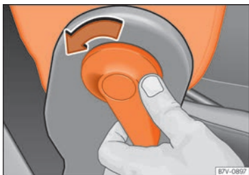
Abb. 139 Klappbare Beifahrersitzlehne entriegeln.
