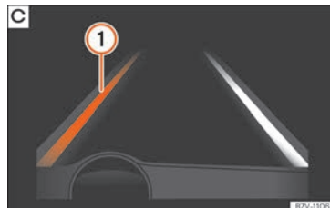
Abb. 258 Am Bildschirm des Kombi-Instruments: Bildschirmanzeige des Spurhalteassistenten [Beispiel 2].
