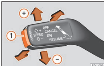
Abb. 245 Links an der Lenksäule: dritter Hebel für die Bedienung der GRA.
