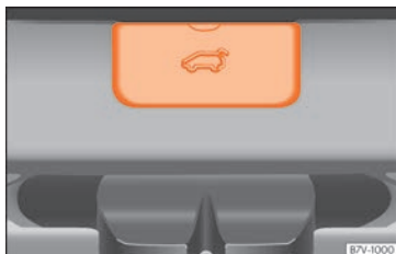
Abb. 107 Detail Gepäckraum: Zugang zur Notentriegelung.
