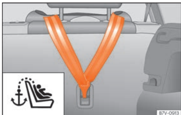
Abb. 31 Rückseite der Rücksitzbank: Halteösen für den Top Tether-Gurt.
