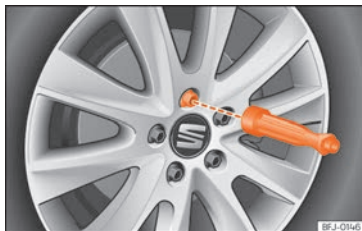
Abb. 49 Radwechsel: Radschrauben mit dem Schraubendrehergriff herausdrehen.
