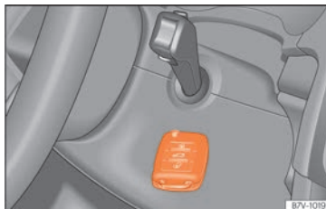
Abb. 235 Notstart bei Fahrzeugen mit Keyless Access.
