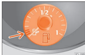
Abb. 78 Im Kombiinstrument: Kraftstoffvorratsanzeige für Benzin und Diesel. »
