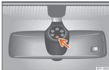
Abb. 122 Sensitive Fläche des Regensensors.
