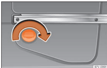
Abb. 284 Im Gepäckraum hinten links: AdBlue-Tank, hinter einer Abdeckung.
