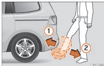
Abb. 106 Heckklappe mit sensorgesteuerter Öffnung (Easy Open).
