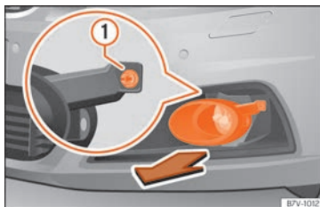
Abb. 66 Im Stoßfänger vorn rechts: Ausbau der Scheinwerfer.
