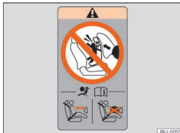
Abb. 28 Airbagaufkleber: Im hinteren Rahmen der Beifahrertür
