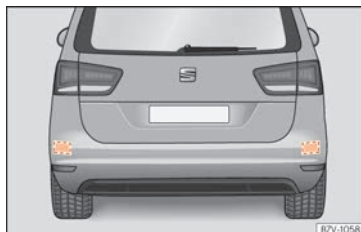
Abb. 261 Heckansicht des Fahrzeugs: Bereiche der Radarsensoren.
