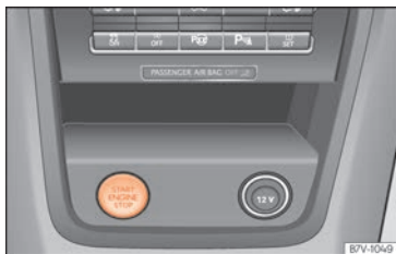
Abb. 234 In der Mittelkonsole: Starterknopf des schlüssellosen Schließ- und Startsystems Keyless Access. Bei Rechtslenker-Fahrzeugen ist die Anordnung symmetrisch.
