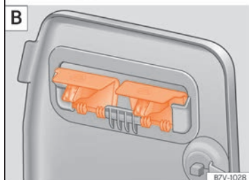
Abb. 142 Abdeckung der Aufnahme der Gepäckraumabdeckung abnehmen A und sicher verstauen B.
