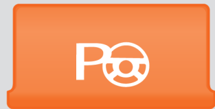
Abb. 269 Ansicht der Mittelkonsole: Taste zum manuellen Einschalten des Parklenkassistenten.
