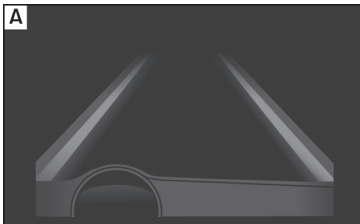
Abb. 258 Am Bildschirm des Kombi-Instruments: Bildschirmanzeige des Spurhalteassistenten [Beispiel 2].
