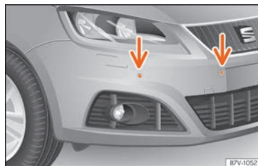
Abb. 272 Sensoren der Parkdistanzkontrolle vorn im Stoßfänger.
