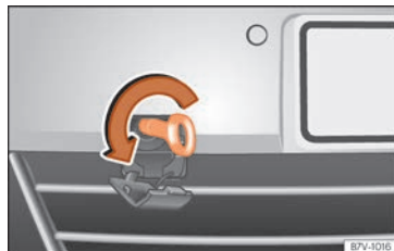
Abb. 56 Im Stoßfänger vorn rechts: Abschleppöse einschrauben.
