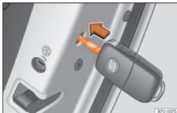
Abb. 97 Notverriegelung des Fahrzeugs mit dem Fahrzeugschlüssel.
