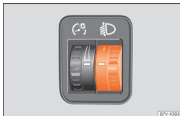
Abb. 118 Neben dem Lenkrad: Regler für die Leuchtweitenregulierung.
