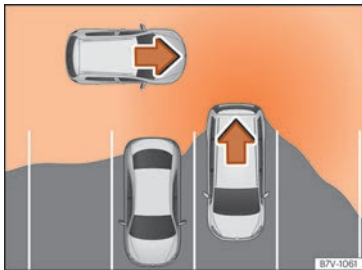
Abb. 264 Schematische Abbildung des Ausparkassistenten: Überwacher Bereich des ausparkenden Fahrzeugs.
