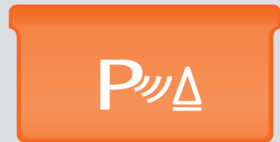
Abb. 271 Ansicht der Mittelkonsole: Taste zum Einschalten und Ausschalten der Einparkhilfe.
