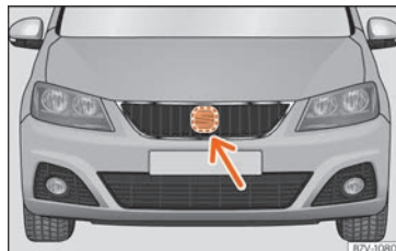
Abb. 247 Im Frontbereich hinter dem SEAT-Emblem: Radarsensor.
