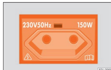
Abb. 172 Ausschnitt aus der hinteren Mittelkonsole: 230-Volt-Eurosteckdose.
