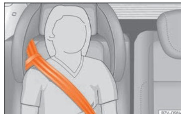
Abb. 35 Integrierter Kindersitz: Gurtbandverlauf mit Gurtführungsschleufe.
