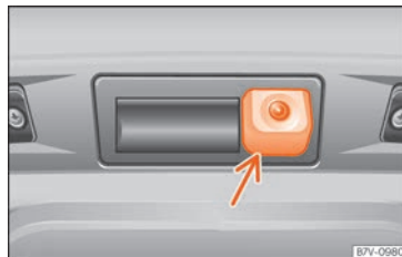
Abb. 275 An der Gepäckraumklappe: Einbaulort der Kamera des Rückfahrassistenten.
