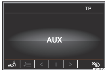
Abb. 25 Medien-Betrieb: Externe Audioquelle über AUX-IN-Buchse angeschlossen.
