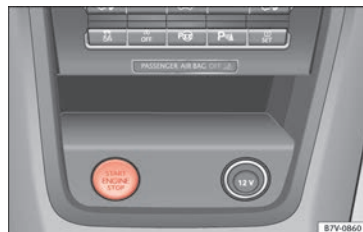
Abb. 198 In der Mittelkonsole: Starterknopf des schlüssellosen Schließ- und Startsystem Keyless Access. Bei Rechtslenker-Fahrzeugen ist die Anordnung symmetrisch.
