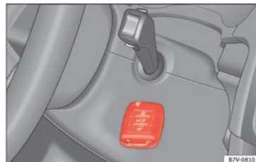
Abb. 199 Notstart bei Fahrzeugen mit Keyless Access.
