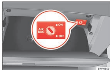
Abb. 91 Im Handschuhfach, auf der Beifahrerseite: Schlüsselschalter zum Ab- und Einschalten des Beifahrer-Frontairbags.
