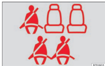
Abb. 82 Beispiel der Gurtstatusanzeige für die hinteren Sitzplätze (hier beim 7-Sitzer) im Kombiinstrument: oben zweite Sitzreihe, unten dritte Sitzreihe.
