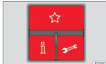
Abb. 122 Drei-Tasten-Modul im Himmel: Bedienelemente des Telefonsteuerungssystems.
