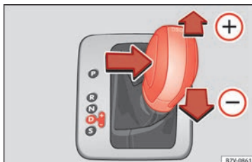
Abb. 202 Wählhebel in Tiptronic-Stellung (Linkslenker). Rechtslenker spiegelbildlich.
