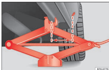
Abb. 69 Wagenheber hinten an der linken Fahrzeugseite angesetzt.
