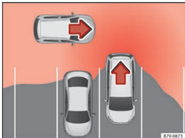
Abb. 225 Schematische Abbildung des Ausparkassistenten: Überwachter Bereich des ausparkenden Fahrzeugs.
