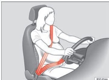
Abb. 87 Gurtbandverlauf bei schwangeren Frauen.
