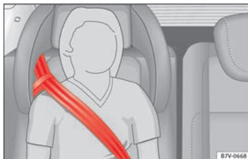
Abb. 95 Integrierter Kindersitz: Gurtbandverlauf mit Gurtführungsschleufe.
