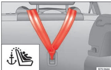
Abb. 38 Eingehängter oberer Befestigungsgurt im Gepäckraum.
