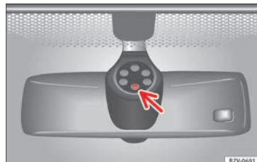
Abb. 144 Sensitive Fläche des Regensensors.
