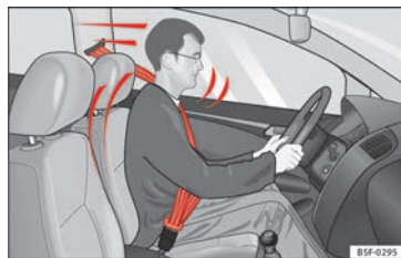
Abb. 83 Angegurteter Fahrer, der bei einem plötzlichen Bremsmanöver vom richtig angelegten Sicherheitsgurt aufgefangen wird.
