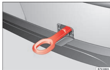
Abb. 103 Im Stoßfänger hinten rechts: Eingeschraubte Abschleppöse.
