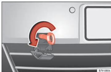
Abb. 102 Im Stoßfänger vorn rechts: Abschleppöse einschrauben.
