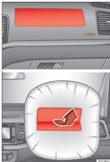
Abb. 26 Einbauort und Wirkungsbereich des Beifahrer-Frontairbags.
