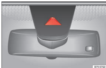
Abb. 219 An der Frontscheibe: Kamerasichtfenster des Spurhalteassistenten.
