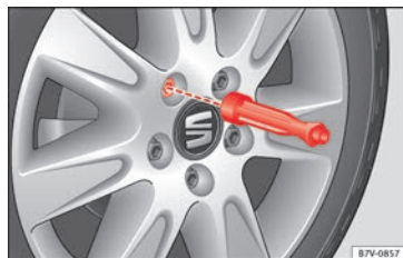
Abb. 70 Radwechsel: Radschrauben mit dem Schraubendrehergriff abschrauben.
