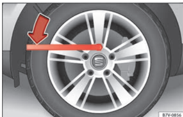
Abb. 66 Radwechsel: Radschrauben lockern.
