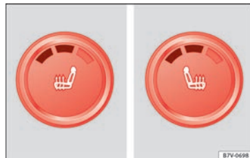
Abb. 153 Ausschnitt aus der Mittelkonsole: Regler für die Sitzheizung der Vordersitze, hier bei eingestellter zweiter Heizstufe.
