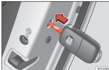
Abb. 5 Notverriegelung des Fahrzeugs mit dem Fahrzeugschlüssel.
