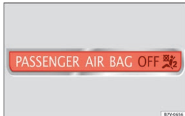
Abb. 90 Kontrollleuchte in der Instrumententafel für abgeschalteten Beifahrer-Frontairbag.
