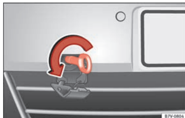
Abb. 71 Im Stoßfänger vorn rechts: Abschleppöse einschrauben.
