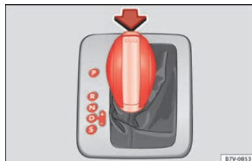
Abb. 201 Wählhebel des automatischen Getriebes mit Sperrtaste (Pfeil).
