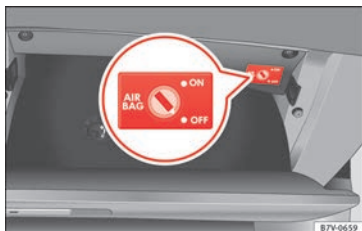
Abb. 27 Im Handschuhfach, auf der Beifahrerseite: Schlüsselschalter zum Ab- und Einschalten des Beifahrer-Frontairbags.
