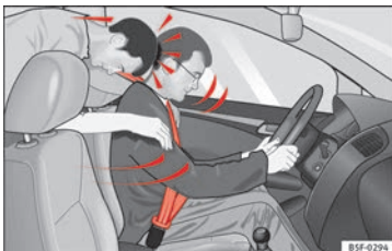
Abb. 85 Der nicht angegurtete Mitfahrer auf dem Rücksitz schleudert nach vorn auf den angegurteten Fahrer.
