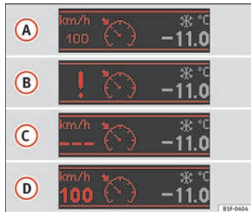
Abb. 218 Display des Kombiinstruments: Zustandsanzeigen der GRA.
