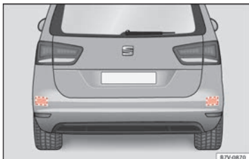
Abb. 222 Bereich hinter dem Fahrzeug: Bereiche der Radarsensoren.
