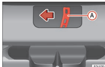
Abb. 9 Vom Gepäckraum aus: Heckklappe notentriegeln.
