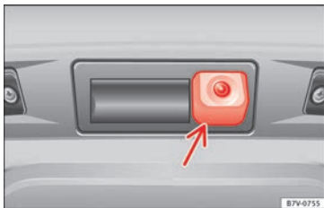
Abb. 214 In der Heckklappe: Einbautort der Kamera des Rückfahrassistenten.
