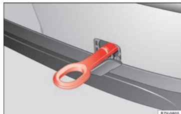
Abb. 72 Im Stoßfänger hinten rechts: Eingeschraubte Abschleppöse.
