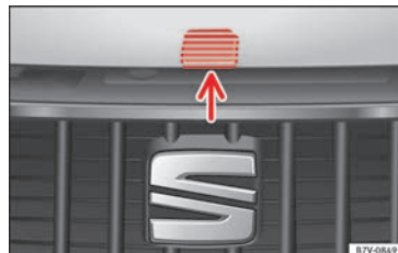
Abb. 240 Entriegelungshebel zum Öffnen der Motorraumklappe im Kühlergrill.
