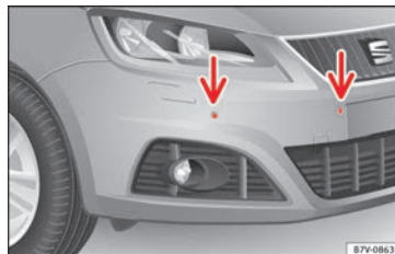
Abb. 208 Sensoren der Parkdistanzkontrolle vorn im Stoßfänger.
