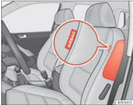
Abb. 20 Seitlich im Vordersitz: Einbauort des Seitenairbags.
