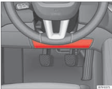
Abb. 24 Auf der Fahrerseite: Einbauort des Knieairbags.
