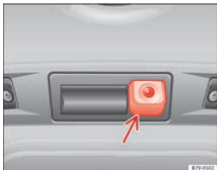
Abb. 145 In der Heckklappe: Einbauort der Kamera des Rückfahrassistenten.
