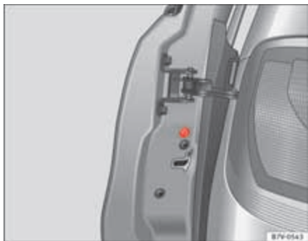
Abb. 186 In der Stirnseite der Beifahrertür: Notverriegelung, durch eine Gummidichtung abgedeckt.
