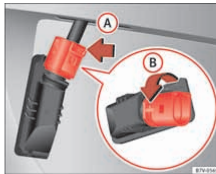
Abb. 211 Kennzeichenleuchte: Lampenhalter ausbauen.
