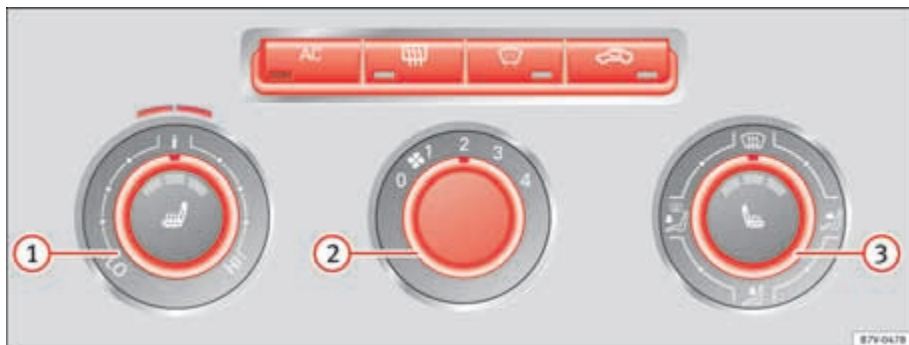
Abb. 121 Ansicht der Mittelkonsole: Bedienungselemente der Climatic.
