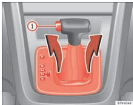
Abb. 192 Abdeckung der Schaltkulisse abbauen.
