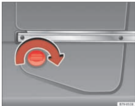
Abb. 161 Hinten links im Gepäckraum: AdBlue-Tank hinter einer Abdeckung.
