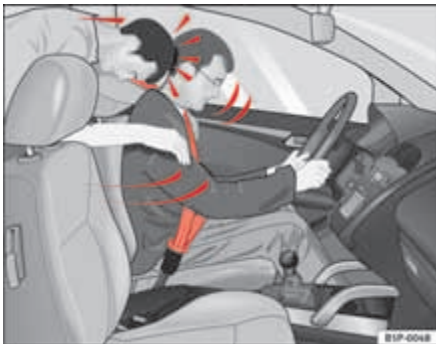
Abb. 8 Der nicht angegurte Mitfahrer auf dem Rücksitz schleudert nach vorn auf den angegurten Fahrer.
