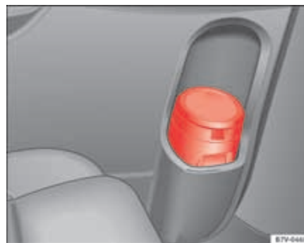
Abb. 112 In der Türverkleidung der linken Schiebetür: mobiler Abfallbehälter.
