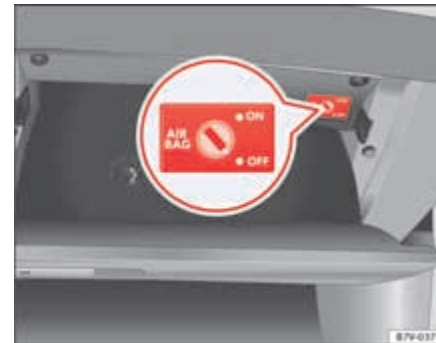
Abb. 19 Im Handschuhfach: Schlüsselschalter zum Ab- und Einschalten des Beifahrer-Frontairbags.
