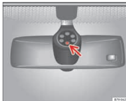
Abb. 70 Sensitive Fläche des Regensensors.
