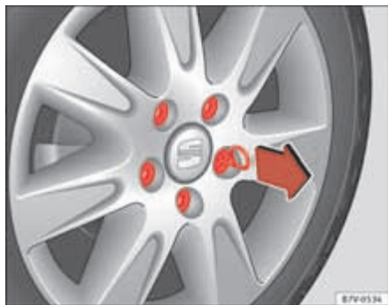
Abb. 177 Abdeckkappen von den Radschrauben abziehen.
