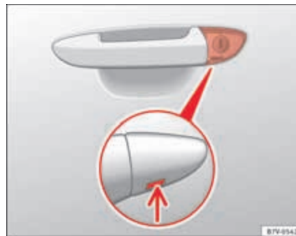
Abb. 185 Türgriff an der Fahrertür: verdeckter Schließzylinder.
