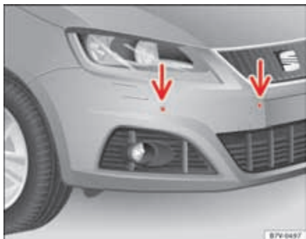
Abb. 140 Sensoren der Parkdistanzkontrolle vorn im Stoßfänger.
