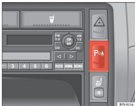
Abb. 132 Ausschnitt aus der Instrumententafel: Schalter für Parkdistanzkontrolle
