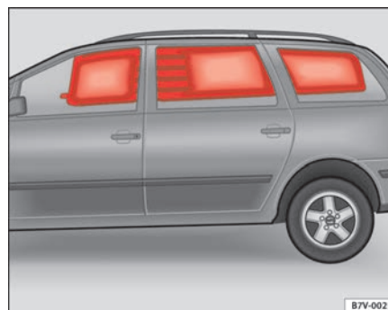
Abb. 27 Prinzipdarstellung: Aufgeblasener Kopfairbag
