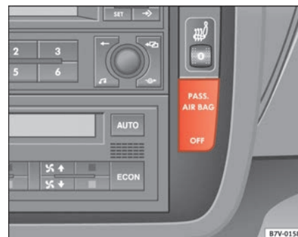
Abb. 29 Kontrollleuchte in der Instrumententafel für Airbagschaltung
