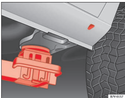
Abb. 176 Anheben mit der Hebebühne: Aufnahmepunkt hinten links
