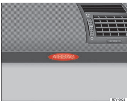
Abb. 23 Einbauort Beifahrer-Frontairbag: in der Instrumententafel
