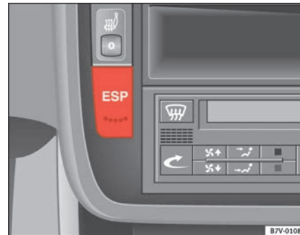
Abb. 125 Ausschnitt aus der Instrumententafel: ESP-Taste
