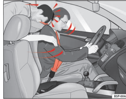
Abb. 8 Der nicht angegurte Mitfahrer auf dem Rücksitz schleudert nach vorne auf den angegurten Fahrer
