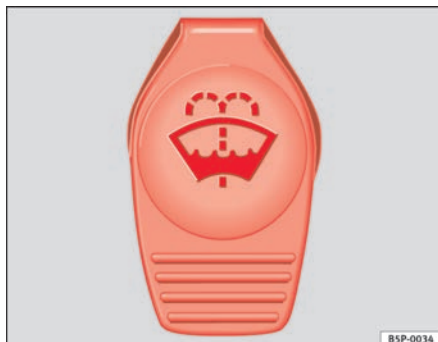
Abb. 144 Im Motorraum: Deckel des Scheiben- waschwasserbehälters
