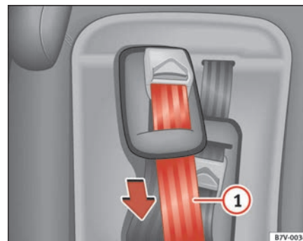
Abb. 38 Integrierter Kindersitz: Einstellung des Hosenträgergurtes
