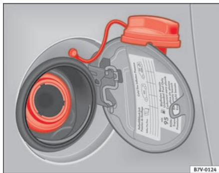
Abb. 137 Tankeinfüllstutzen und Tankklappe
