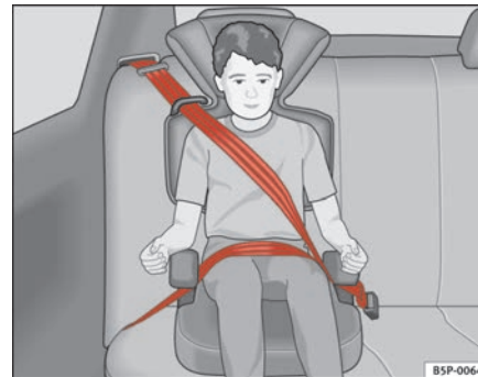
Abb. 32 In Fahrtrichtung eingebauter Kindersitz auf dem Rücksitz
