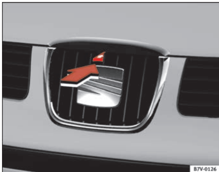
Abb. 139 Ausschnitt aus dem Kühlergrill: Hebel zum Öffnen der Motorraumklappe
