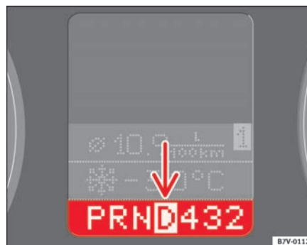
Abb. 129 Kombiinstrument: Anzeige für Wählhebelstellung
