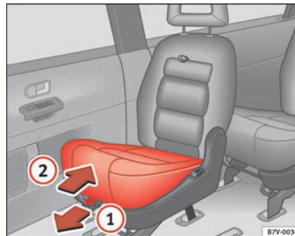
Abb. 41 Bedienung des integrierten Kindersitzes
