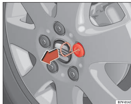
Abb. 157 Abdeckkappe mit dem Drahtbügel abziehen
