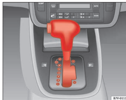
Abb. 128 Mittelkonsole: Wählhebel mit Sperrtaste des Automatikgetriebes
