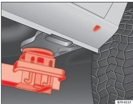
Abb. 176 Anheben mit der Hebebühne: Aufnahmepunkt hinten links
