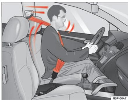
**Abb. 9** Angegurter Fahrer, der bei einem plötzlichem Bremsmanöver vom richtig angelegten Sicherheitsgurt aufgefangen wird
