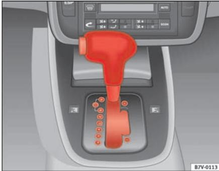
Abb. 130 Ausschnitt aus der Mittelkonsole: Wählhebel mit Sperrtaste
