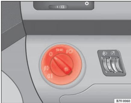
Abb. 71 Ausschnitt aus der Instrumententafel: Schalter für Licht, Nebelscheinwerfer und Nebelschlussleuchte
