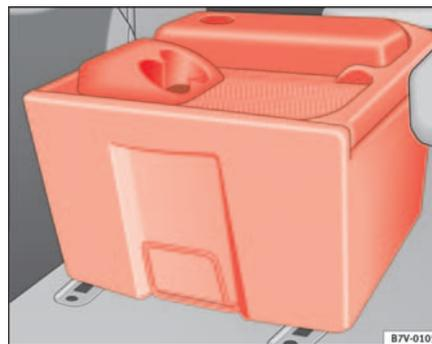
**Abb. 117 Kühl- und Warmhaltebox in eingebautem Zustand**
