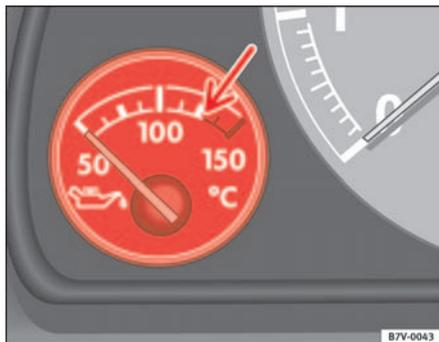
Abb. 47 Motoröltemperatur-Anzeige
