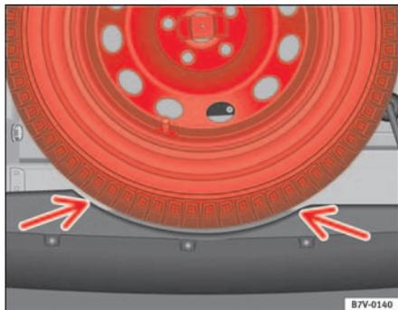
Abb. 154 Aussparung für das Reserverad im Stoßfänger
