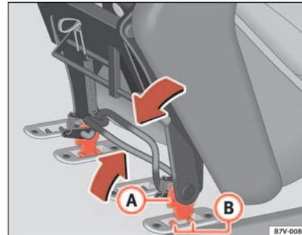
Abb. 94 Sitz einbauen: Bügel und Haltebolzen
