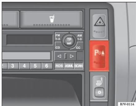
Abb. 132 Ausschnitt von der Instrumententafel: Taste für Park-Distanz-Kontrolle
