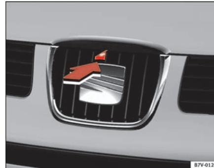
Abb. 140 Ausschnitt aus dem Kühlergrill: Öffnen der Motorraumklappe
