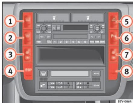
Abb. 79 Ausschnitt aus der Mittelkonsole: Taste für Frontscheibenbeheizung
