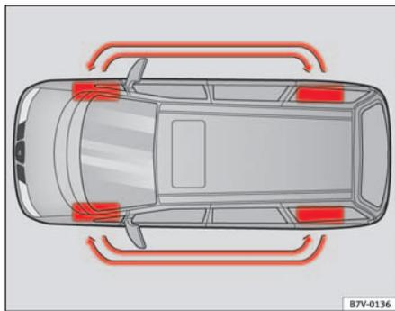
Abb. 151 Schema für das Tauschen der Räder
