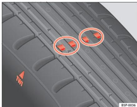
Abb. 150 Prinzipdarstellung Reifenprofil: Verschleißanzeiger
