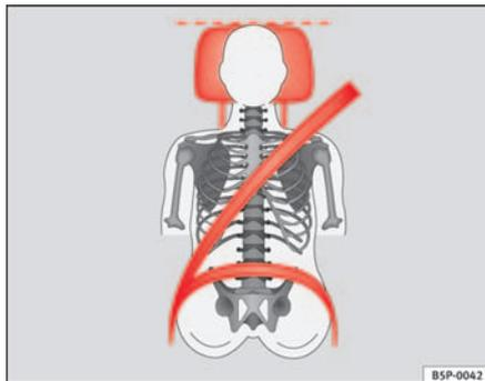
**Abb. 84** Von vorne betrachtet: richtig eingestellte Kopfstütze und korrekter Gurtbandverlauf
