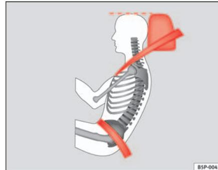
**Abb. 85** Von der Seite betrachtet: richtig eingestellte Kopfstütze und korrekter Gurtbandverlauf
