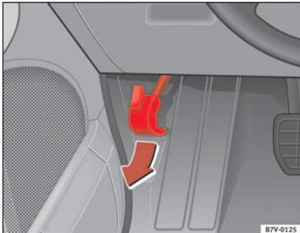
Abb. 139 Ausschnitt aus dem Fußraum auf der Fahrerseite: Entriegelungshebel für die Motorraumklappe
