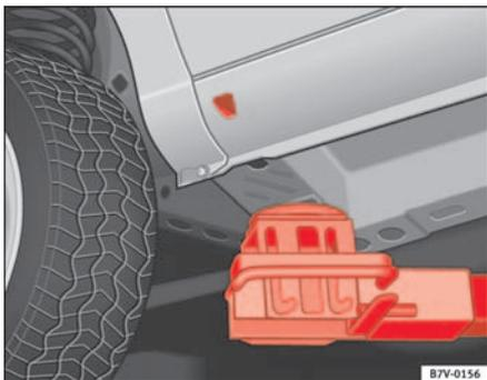
Abb. 175 Anheben mit der Hebebühne: Aufnahmepunkt vorne links
