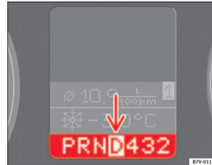
**Abb. 129** Ausschnitt aus dem Kombiinstrument: Display mit eingeleger Wählhebelstellung
