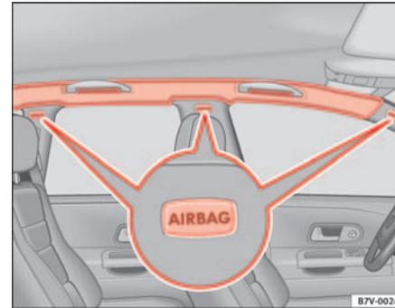
**Abb. 26** Einbauort der Kopfairbags auf der linken Fahrerseite
