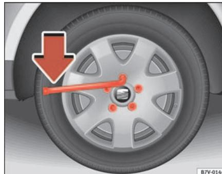
Abb. 158 Radwechsel: Radschrauben lockern
