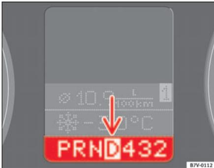
Abb. 131 Ausschnitt aus dem Kombiinstrument: Display mit eingelegter Wählhebelstellung
