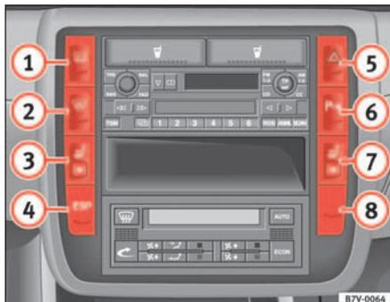
Abb. 73 Schalter für Warnblinkanlage
