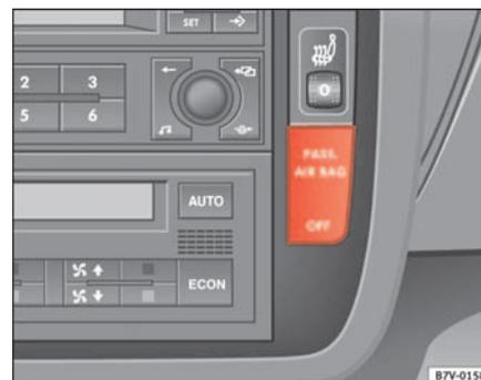
**Abb. 29** Kontrollleuchte in der Instrumententafel für Airbagabschaltung
