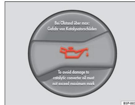
**Abb. 143** Deckel der Motoröl-Einfüllöffnung im Motorraum
