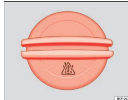
Abb. 144 Im Motorraum: Deckel des Kühlmittel-Ausgleichsbehälters
