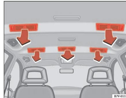
Abb. 122 Kaltluft-Dachausströmer
