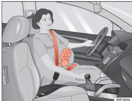
Abb. 14 Gurtbandverlauf bei schwangeren Frauen
