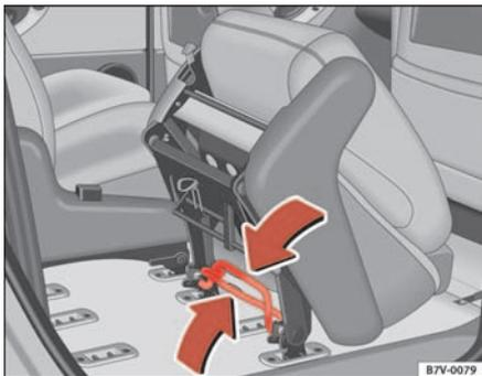
Abb. 93 Bügel zum Aus- und Einbauen des Einzelsitzes
