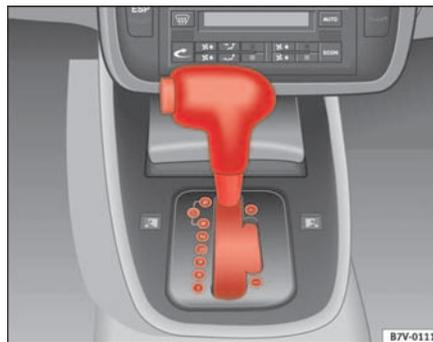
Abb. 128 Ausschnitt von der Mittelkonsole: Wählhebel mit Sperrtaste vom Automatikgetriebe ▶
