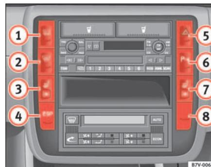
**Abb. 88 Mittelkonsole: Regler für die Sitzheizung**
