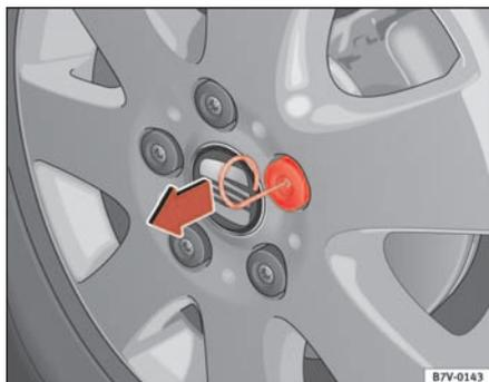
Abb. 157 Abdeckkappe mit dem Drahtbügel abziehen
