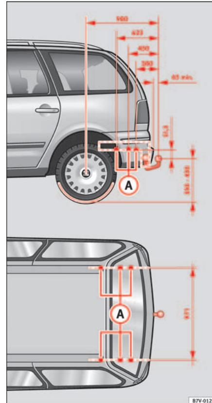
Abb. 137 Befestigungspunkte für die Anhängervorrichtung
