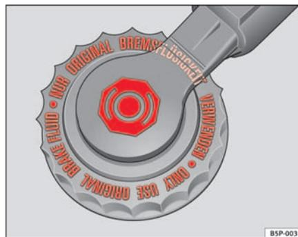
**Abb. 149** Im Motorraum: Abdeckung des Bremsflüssigkeitsbehälters
