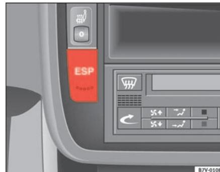
Abb. 125 Ausschnitt von der Instrumententafel: ESP-Taste
