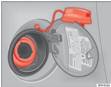
Abb. 138 Tankeinfüllstutzen und Tankklappe
