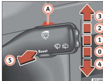
Abb. 80 Scheibenwischer- und Scheibenwascherhebel
