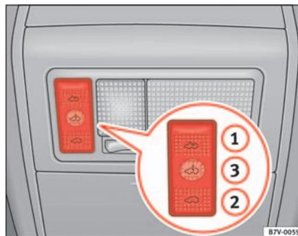
**Abb. 68 Ausschnitt vom Dachhimmel: Schalter für das Schiebe-/Ausstelldach**
