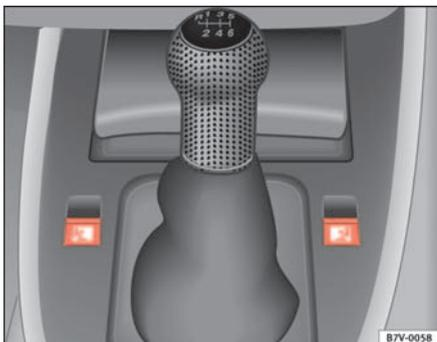
Abb. 66 Bedienelemente für elektrische Ausstellfenster
