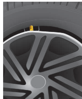
Falsche Ventilposition: unter dem Ring.
