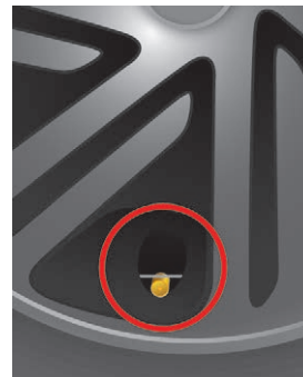
Falsche Ventilposition: unter dem Ring.
