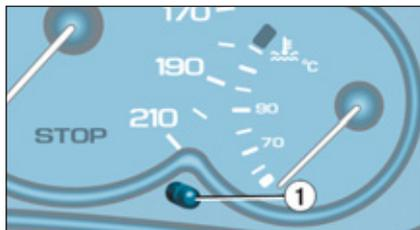
Durch Druck auf Knopf 1 wechselt die Anzeige zwischen Gesamt- und Tageskilometerstand.
