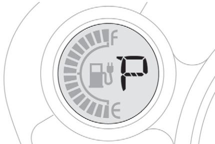
Bei laufendem Motor erscheint **P** auf der Anzeige des Kombiinstruments.
