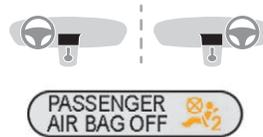
Die Airbag-Kontrollleuchte auf dem Kombiinstrument leuchtet und bleibt so lange eingeschaltet, bis der Airbag deaktiviert ist.
