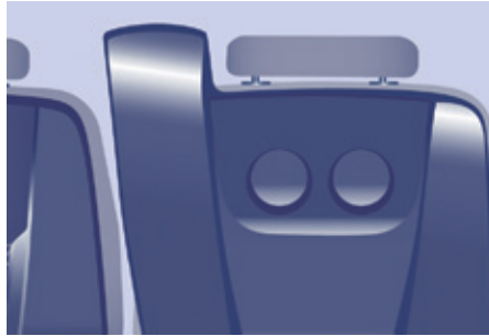
Die Rückenlehnen der mittleren Sitze sind mit eingeformten Becherhaltern und Ablageschalen versehen.
