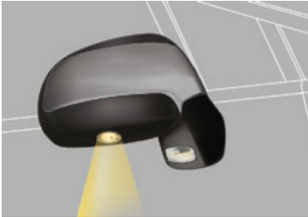
Um den Zugang zum Fahrzeug zu erleichtern, beleuchten sie:
