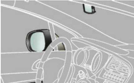
Spiegel für die seitliche Sicht nach hinten, die wichtig zum Überholen oder Einparken sind. Zum Parken an einem Engpass können sie auch eingeklappt werden.
