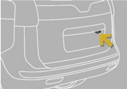
Bei Einlegen des Rückwärtsgangs wird die Rückfahrkamera automatisch aktiviert. Die Kamera liefert ein Farbbild auf dem Navigationsbildschirm.
