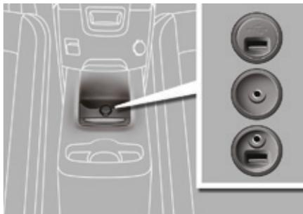
Diese Anschlusseinheit besteht aus einem JACK-Anschluss und/oder einem USB-Ausgang. An ihr lässt sich ein tragbares Gerät, wie ein iPod® oder ein USB-Stick anschließen.
