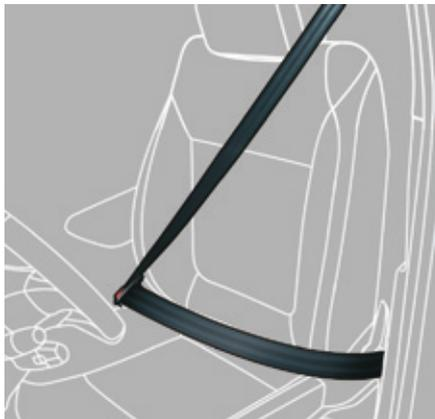
Die vorderen Sicherheitsgurte sind mit pyrotechnischen Gurtraffern und Gurtkraftbegrenzern ausgestattet.
