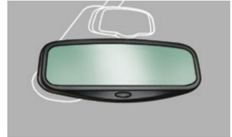
Mit Hilfe eines Sensors, der die Lichtverhältnisse hinter dem Fahrzeug misst, stellt sich der Rückspiegel selbsttätig und stufenlos von Tageslicht auf Dunkelheit um.
