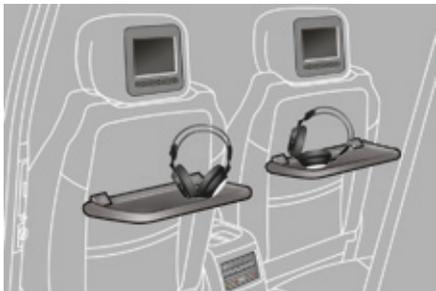
Dieses Multimedia-System ermöglicht den Insassen im Fond ein oder zwei externe mobile Geräte anzuschließen (tragbare Audio- oder Videogeräte, Spielkonsole, DVD-Player ...). Der Ton wird mittels der beiden drahtlosen Bluetooth®-Kopfhörer übertragen, während der Videoinhalt über zwei 7"-Bildschirme wiedergegeben wird, die auf der Kopfstützenrückseite der Vordersitze integriert sind.
