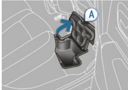
Je nach Konfiguration, ist das Fahrzeug mit Ablagefächern im Fußraum ausgestattet, die sich vor den seitlichen Rücksitzen befinden. Sie können mit dem Griff A an der Klappe mit Einrastfunktion geöffnet werden.
