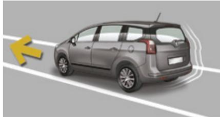
**An Steigungen wird das stehende Fahrzeug beim Lösen des Bremspedals kurzzeitig angehalten:**
