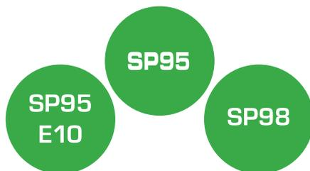
Die Benzinmotoren sind so konzipiert, dass sie mit Biokraftstoffen für Benzinmotoren vom Typ E10 (mit 10 % Ethanol) gemäß den europäischen Normen EN 228 und EN 15376 betrieben werden können. Kraftstoffe vom Typ E85 (mit bis zu 85 % Ethanol) sind ausschließlich für Fahrzeuge bestimmt, deren Motoren speziell für diese Art von Kraftstoff ausgelegt sind (BioFlex-Fahrzeuge). Die Ethanol-Qualität muss der europäischen Norm EN 15293 entsprechen.
