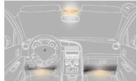
Sie funktioniert wie die Deckenbeleuchtung. Die Leuchten schalten sich beim Öffnen einer Tür ein.
