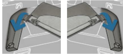
Zum Verstauen mit der Spannrolle nach oben und der Griffleiste nach innen:
