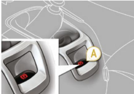
Die elektrische Feststellbremse verfügt über zwei Funktionsarten:
