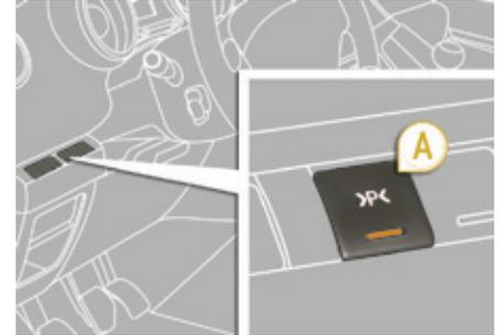
Die Funktion "Parklückendetektor" wird durch Drücken auf die Betätigung **A** aktiviert. Das ständige Einschalten der Kontrollleuchte weist auf die Auswahl der Funktion hin.
