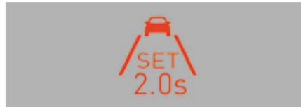
Der Warnwert ist zwischen 0,9 und 2,5 Sekunden einstellbar. Die Warnanzeige kann deaktiviert werden, indem ein Wert von 0 Sekunden programmiert wird.
