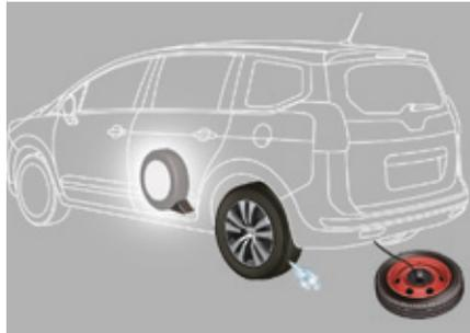
Das Ersatzrad ist mit einer Windenkonstruktion unter dem Fahrzeug befestigt.
