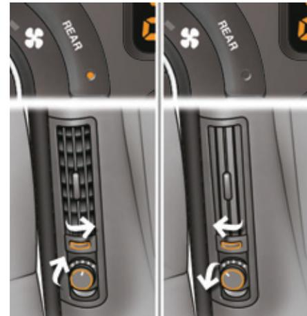
Drehen Sie nach dem Druck auf die Taste "REAR" den Regler für die hinteren seitlichen Belüftungsdüsen, um die Gebläsestärke zu verringern bzw. zu erhöhen. Achten Sie darauf, dass die seitlichen Belüftungsdüsen und die Luftaustritte am Boden nicht verdeckt sind.
