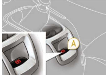
Bei einer Störung der Fußbremsanlage oder in außergewöhnlichen Situationen (Beispiel: Unwohlsein des Fahrers, ...) kann das Fahrzeug durch ununterbrochenes Ziehen der Betätigung **A** angehalten werden.
