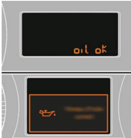
**i** Die Ölstandskontrolle ist nur zuverlässig, wenn das Fahrzeug waagrecht steht und der Motor seit mehr als 30 Minuten abgestellt ist.
