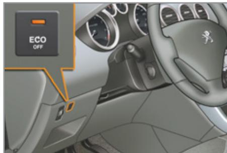
Drücken Sie jederzeit die Taste **"ECO OFF"**, um das System zu deaktivieren. Die Deaktivierung wird durch Aufleuchten der Kontrollleuchte der Betätigung in Verbindung mit einer Meldung auf dem Bildschirm angezeigt.
