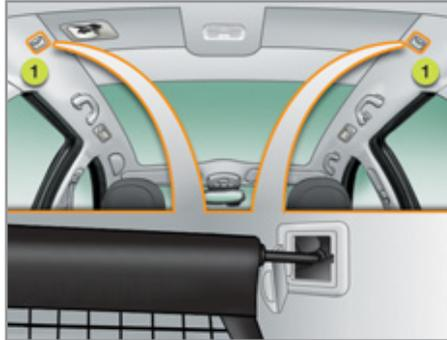
**i** Wenn Sie das Netz anbringen, achten Sie bitte darauf, dass die Schlaufen der Riemen vom Kofferraum aus zu sehen sind; sie lassen sich dann leichter lockern oder spannen.
