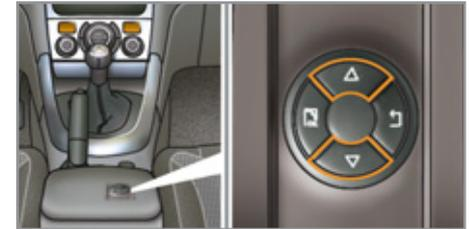
☞ Drücken Sie auf die nach oben und unten weisenden Pfeile des zum WIP Com 3D gehörenden **Steuerfelds** des Kombiinstrument, um die Informationen nacheinander abzurufen.
