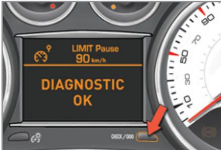
☞ Um den manuellen Check zu starten, drücken Sie bei laufendem Motor kurz auf den Knopf "CHECK/000" im Kombiinstrument.
