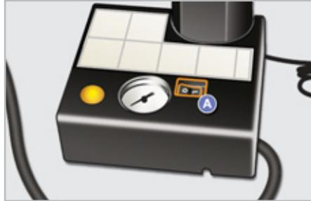
**i** Sollten Sie diesen Druckwert nach ca. fünf bis zehn Minuten nicht erreichen, so ist der Reifen nicht reparabel. Wenden Sie sich an einen Vertreter des PEUGEOT-Händler-netzes oder an eine qualifizierte Werkstatt, um die Panne beheben zu lassen.
