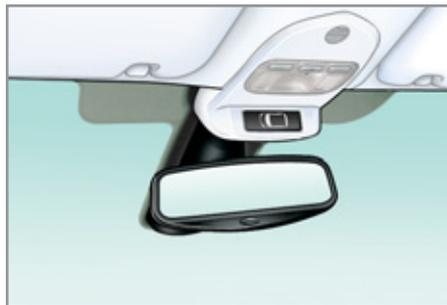
**i** Um optimale Sicht beim Manövrieren zu gewährleisten, wird der Spiegel automatisch heller, sobald der Rückwärtsgang eingelegt wird.
