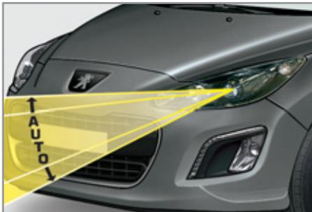
Um andere Verkehrsteilnehmer nicht zu behindern, korrigiert dieses System im Stand automatisch die Höhe des Xenon-Scheinwerferkegels entsprechend der Fahrzeugbelastung.
