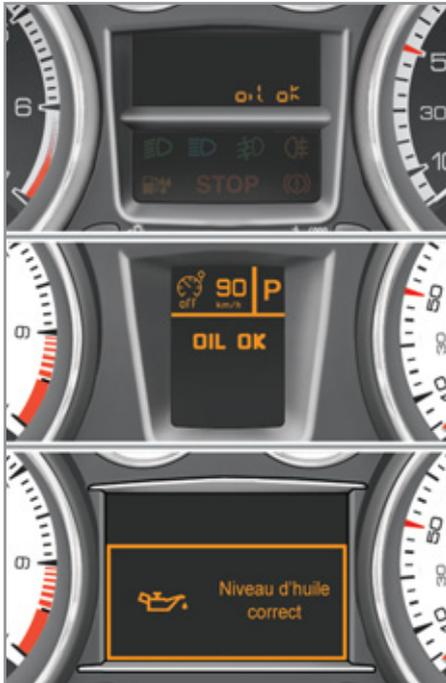
Beim Einschalten der Zündung wird nach der Wartungsinformation für die Dauer einiger Sekunden der Motorölstand angezeigt.
