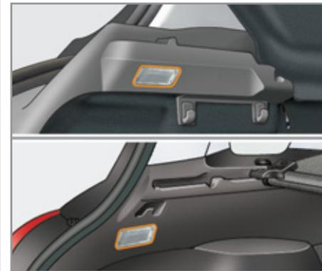
Sie schaltet sich automatisch beim Öffnen des Kofferraums ein und erlischt, wenn er wieder geschlossen wird.
