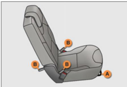
☞ Heben Sie den Bügel **A** an und schieben Sie den Sitz nach vorn oder hinten.
