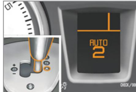
Der eingelegte Gang bzw. der gewählte Fahrmodus erscheinen in der Anzeige im Kombiinstrument.
