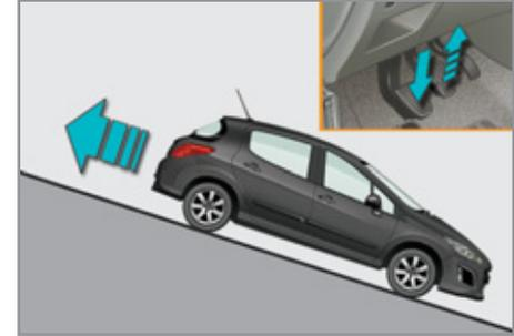
**Im Gefälle wird das stehende Fahrzeug bei eingelegtem Rückwärtsgang kurzzeitig angehalten, wenn das Bremspedal gelöst wird.**
