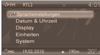
Drücken Sie die Taste **"SETUP"**, um zum Menü **"SETUP"** zu gelangen. In diesem Menü können Sie zwischen folgenden Funktionen wählen:
