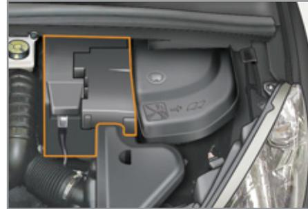
Die Batterie befindet sich im Motorraum.
