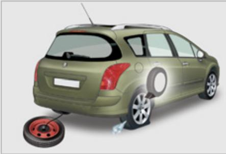
Das Ersatzrad ist mit einer Windenkonstruktion unter dem Fahrzeugheck befestigt.
