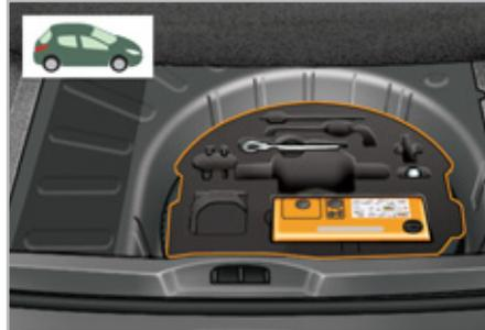
Das Set befindet sich im Kofferraum unter dem Boden. Es liegt in dem unter dem Staukasten befindlichen Werkzeugkasten.
