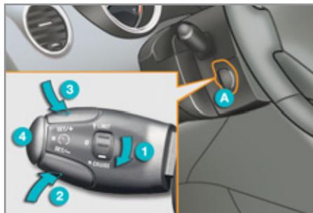
Die Bedienung des Geschwindigkeitsreglers erfolgt über den Hebel **A**.
