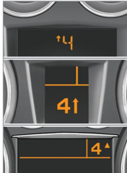
Der Hinweis erscheint in Form eines Pfeils in Verbindung mit dem empfohlenen Gang im Kombiinstrument.
