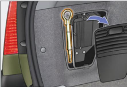
Die Abschleppöse befindet sich in der linken Seitenverkleidung des Kofferraums.
