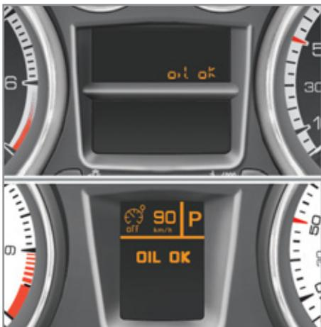
Bei den mit einer elektrischen Messfunktion ausgestatteten Versionen wird die Konformität des Motorölstands für die Dauer einiger Sekunden bei Einschalten der Zündung im Anschluss an die Wartungsanzeige im Kombiinstrument angezeigt.
