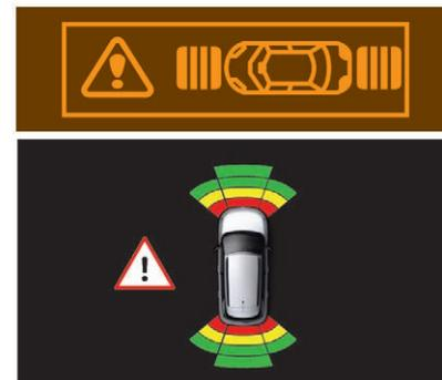
Das akustische Signal wird durch die Anzeige von Segmenten auf dem Bildschirm ergänzt, die sich dem Fahrzeug immer weiter nähern. In unmittelbarer Nähe des Hindernisses erscheint das Symbol „Gefahr“ auf dem Bildschirm.
