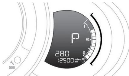
Wenn Sie den Gangwählhebel verstellen, um eine Schaltposition zu wählen, leuchtet die entsprechende Kontrollleuchte auf dem Kombiinstrument auf.
