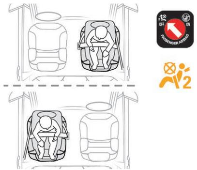
Wenn ein Kindersitz „entgegen der Fahrtrichtung“ auf dem **Beifahrersitz vorne** eingebaut wird, muss der Sitz des Fahrzeugs in die mittlere Längsposition, in höchste Position und mit gerader Rückenlehne eingestellt werden.
