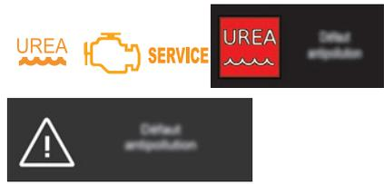
Diese Kontrollleuchten leuchten, in Verbindung mit einem akustischen Signal und der Anzeige der Meldung „Fehler Abgasreinigung“. Der Alarm wird während der Fahrt ausgelöst, sobald die Störung erstmalig erkannt wird, und anschließend bei jedem Einschalten der Zündung aktiviert, sofern die Störung weiterhin besteht.
