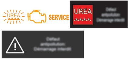
Bei jedem Einschalten der Zündung leuchten diese Warnleuchten, die Warnleuchte UREA blinkt, es ertönt ein Warnsignal und die Meldung „Fehler Abgasreinigung: Anlasser gesperrt“ wird angezeigt.
