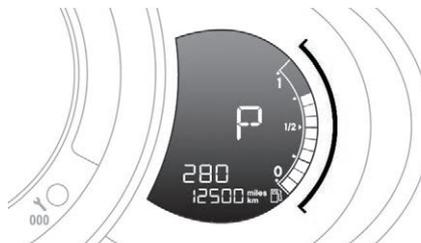
Wenn Sie den Gangwählhebel verstellen, um eine Schaltposition zu wählen, leuchtet die entsprechende Kontrollleuchte auf dem Kombiinstrument auf.
