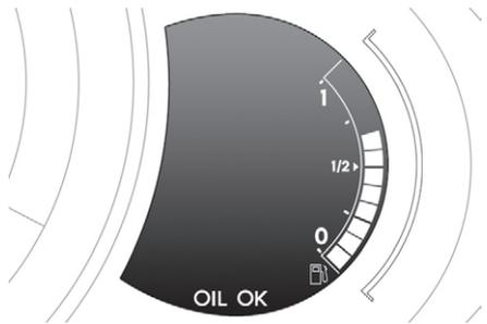
Bei den mit einem elektrischen Ölmesstab ausgestatteten Versionen wird beim Einschalten der Zündung nach der Wartungsinformation für die Dauer einiger Sekunden der Motorölstand auf dem Kombiinstrument angezeigt.
