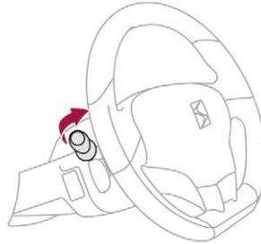
Das kurze Nachleuchten des Abblendlichts nach dem Ausschalten der Zündung dient dazu, dem Fahrer bei geringer Helligkeit das Aussteigen zu erleichtern.
