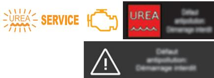
Bei jedem Einschalten der Zündung leuchten die Kontrollleuchten für Service und Motorselbstdiagnose, die Kontrollleuchte UREA blinkt, es ertönt ein Warnsignal und die Meldung "Fehler Abgasreinigung: Anlasser gesperrt" wird angezeigt.
