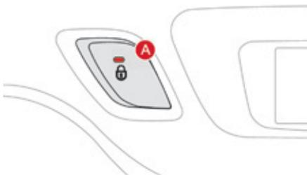
System zur vollständigen manuellen Verriegelung bzw. Entriegelung der Türen von innen.
