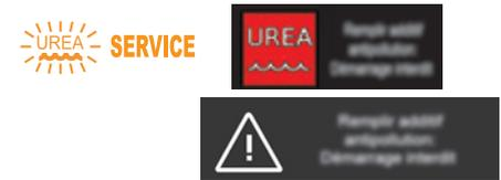
Mit dem Einschalten der Zündung leuchtet die Kontrollleuchte für Service und die Kontrollleuchte UREA blinkt, es ertönt ein Warnsignal und die Meldung "Abgas-Additiv einfüllen: Anlasser gesperrt" wird eingeblendet. Der Additivtank AdBlue® ist leer: die gesetzlich vorgeschriebene Anlassersperre verhindert das Starten des Motors.
