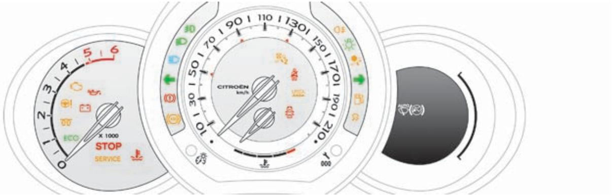
Anzeigen, die den Fahrer über die Aktivierung eines Systems (Kontrollleuchten für Betrieb oder Deaktivierung) oder das Auftreten einer Fehlfunktion (Warnleuchten) informieren.
