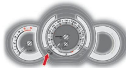
System, das die Deaktivierung bestimmter Anzeigen für die Nachtfahrt ermöglicht. Dabei bleibt das Kombiinstrument zusammen mit der Geschwindigkeitsanzeige, den Informationen des Geschwindigkeitsreglers oder -begrenzers, wenn dieser aktiviert ist, beleuchtet.
