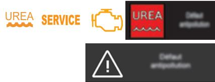
Beim Einschalten der Zündung leuchten die Kontrollleuchten für Service, UREA und Motorselbstdiagnose, es ertönt ein Warnsignal und die Meldung "Fehler Abgasreinigung" zeigt einen Emissionsfehler an.
