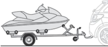
Mechanische Vorrichtung zum Ankuppeln eines Anhängers mit zusätzlicher Signalanlage und Beleuchtung.
