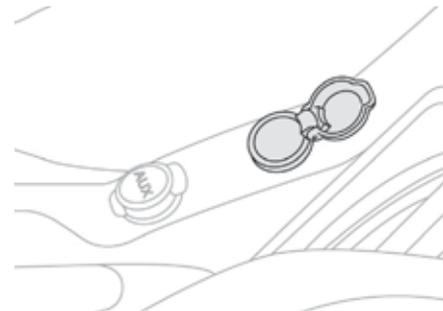
**f** Um ein Zubehörteil mit 12V-Betriebsspannung (maximale Leistung: 120 W) anzuschließen, entfernen Sie die Verschlusskappe und verwenden Sie einen geeigneten Adapter.
