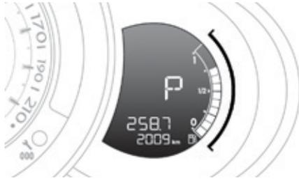
Wenn Sie den Gangwählhebel verstellen, um eine Schaltposition zu wählen, leuchtet die entsprechende Kontrollleuchte im Kombiinstrument auf.
