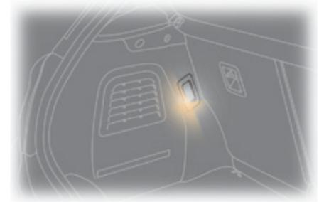
Sie schaltet sich automatisch beim Öffnen des Kofferraums ein und erlischt, wenn er wieder geschlossen wird.
